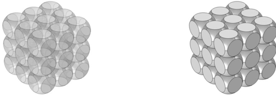
FIGURE 6.5 – Réseau tridimensionnel de sphères se chevauchant légèrement, en vue normale (droite) et transparente (gauche). Les disques séparant les sphères sont appelés pores et permettent de passer d’une sphère à une autre.
