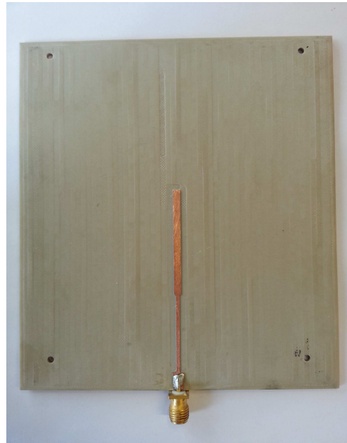
Figure III.3 : Ligne d'alimentation de l'antenne bi-bande (Vue de dessous)
