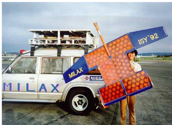
Figure I.2 Pilotage d'avion modèle par énergie RF sans fil ( f = 2.411 GHz)
