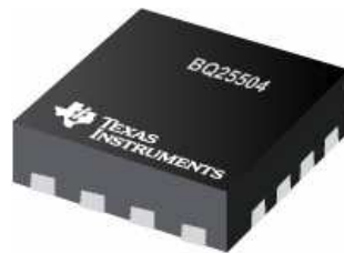
Figure IV.7 Convertisseur DC-DC bq25504 de Texas Instruments à 16 broches (3mm x 3mm)
