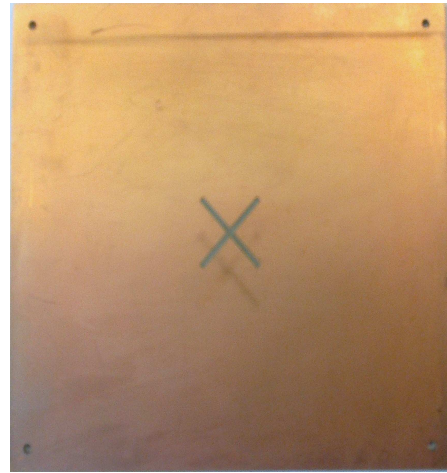
Figure II.6 Fente de couplage en croix sur plan de masse
