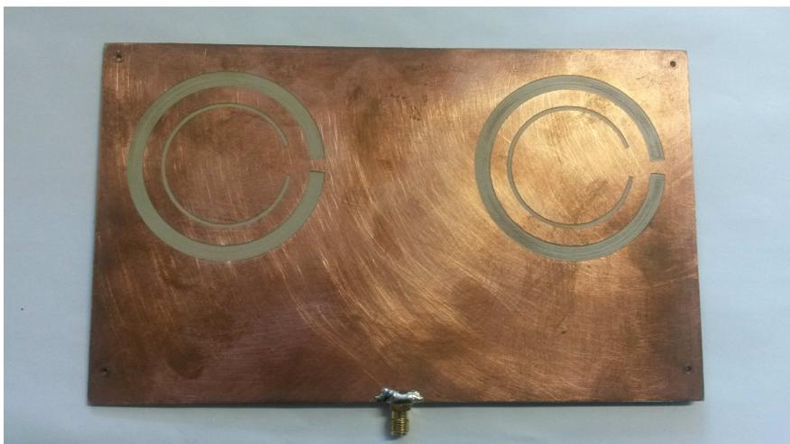
Figure III.31 Réseau d'antennes bi-bande 1x2 (Vue de dessus) : Les fentes circulaires
