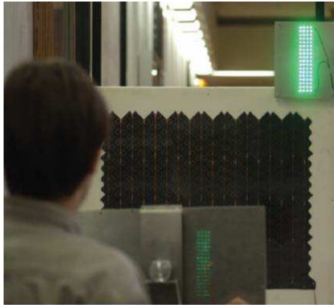
Figure I.6 Démonstrateur : Réseau de rectennas à 5.8 GHz alimentant 72 diodes GaN
