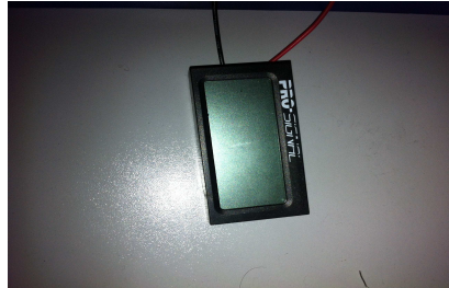
Figure IV.1 Capteur de température à affichage digital
