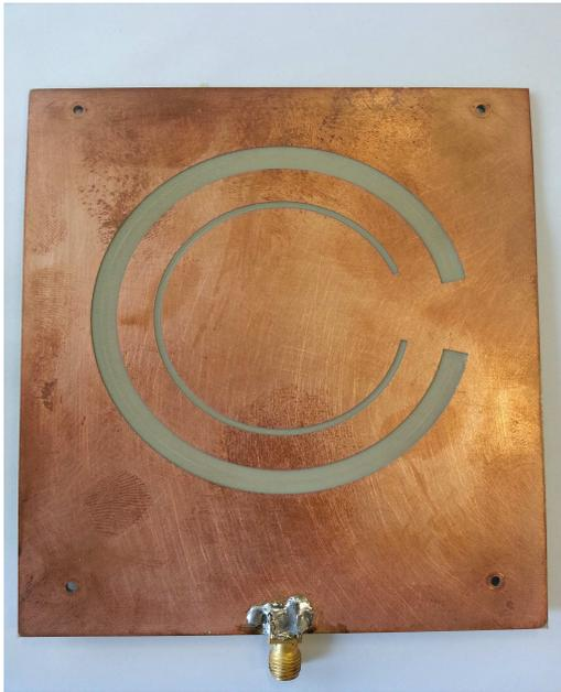
Figure III.2 Les deux fentes circulaires de l'antenne bi-bande (Vue de dessus)
