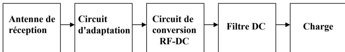
Figure I.9 Différentes parties d'une rectenna faible puissance
