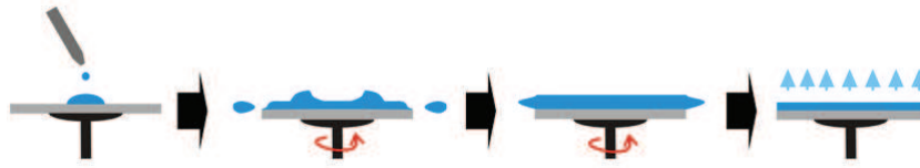
FIGURE 3.2 – Schéma présentant le principe de dépôt par spin-coating
