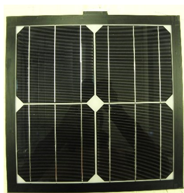
Figure 2.11 – Photographie de notre module monoface de référence M (à gauche), et son rendement ainsi que celui de chaque face du module biface B_{stand1} en fonction de l'éclairement au PASAN en « multi-flash » avec leur approximation logarithmique respectifs (à droite).
