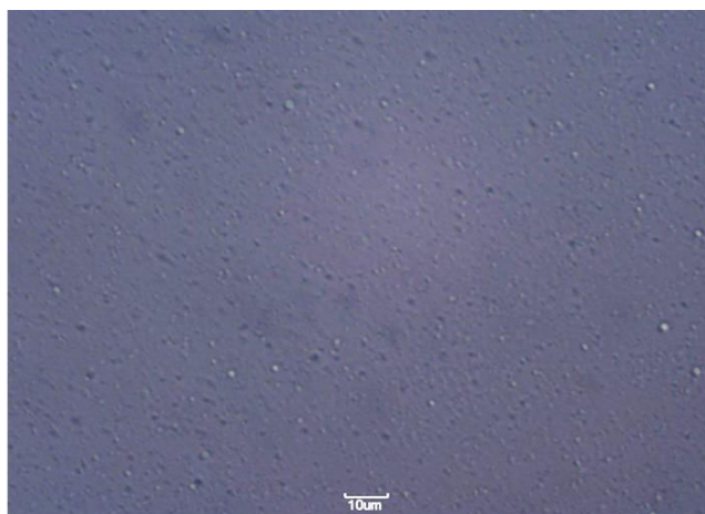
Figure 80 : photos au microscope optique X40 de dispersions de capsules d'oignons de composition lipides/solution aqueuse 55 : 45, la solution aqueuse contenant la chlorhexidine à 20 % (en masse).
