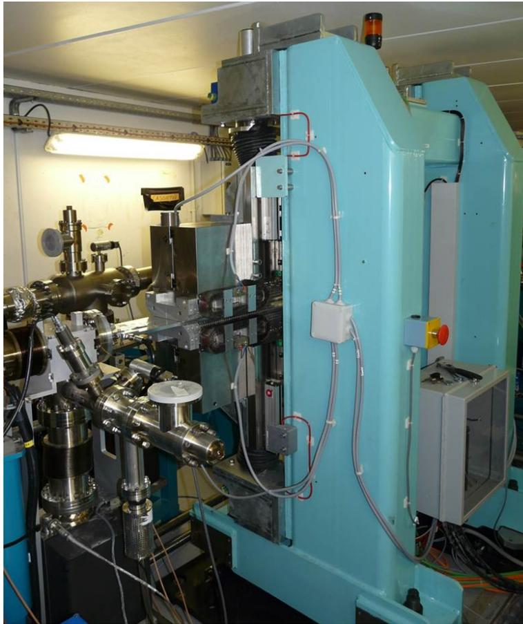
FIGURE 3.35 – Vue de l'onduleur HU36 installé dans la section droite courte 15 de l'anneau de stockage de SOLEIL.
