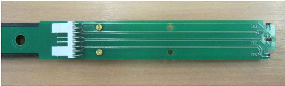
FIGURE 2.16 – Ensemble des trois capteurs à effet Hall soudés sur leur support. Du haut vers le bas, on trouve respectivement les capteurs sensibles à  $B_s$ ,  $B_z$  et  $B_x$ .
