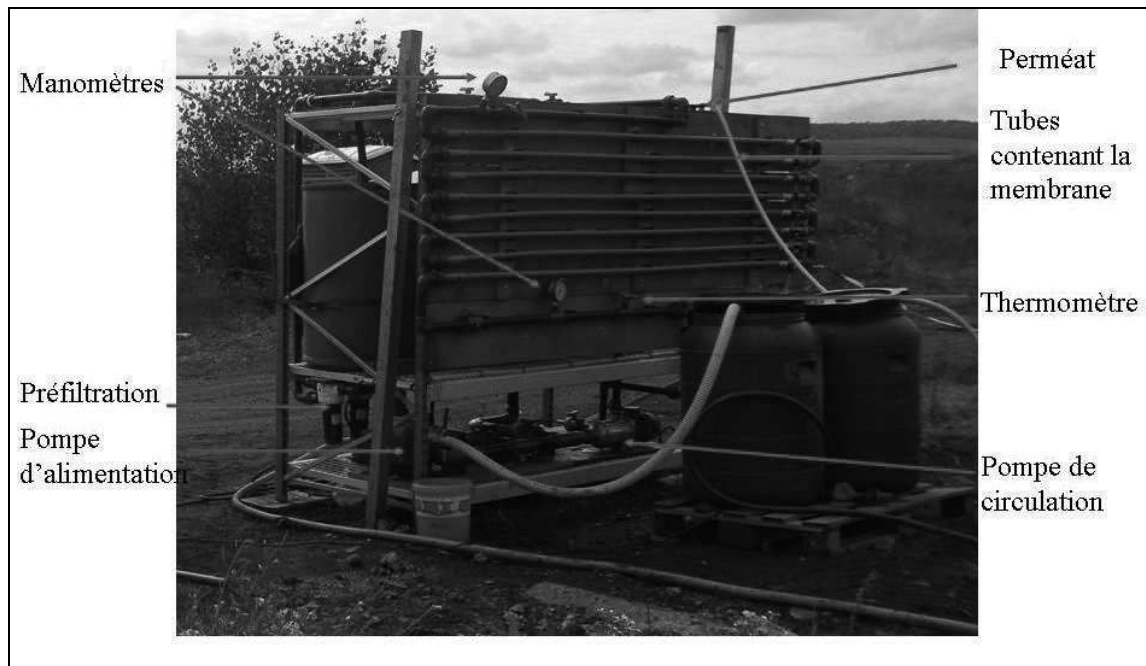
Figure 73 : Pilote d'ultrafiltration.
