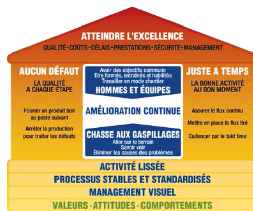
Figure 3- La maison du Système de Production: présente les outils principaux permettant de mettre en place une démarche lean en production
