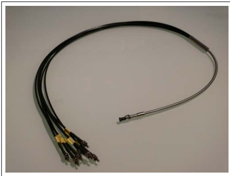
(a) Photographie du combineur de fibres utilisé dans le montage d'interrogation multi-spectrale basé sur 5 LEDs. Le combineur présenté permet de collecter la lumière issue de 7 fibres multimodes de 400 \mu\text{m} de coeur dans une seule fibre de sortie.
