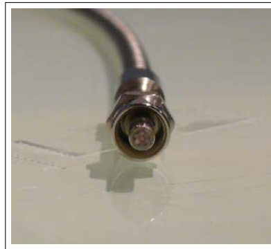
(b) Photographie de la sortie en "nid d'abeille" du combineur de fibres utilisé dans le montage d'interrogation multi-spectrale basé sur 5 LEDs. Les 7 fibres combinées sont associées à des points sources distincts en sortie.
