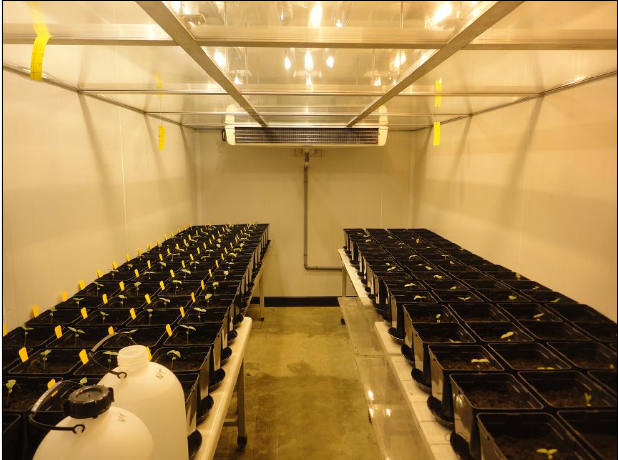
Figure 11 : Chambre de germination où les plantes ont été cultivées pendant deux semaines dans des conditions contrôlées de luminosité ( 250 \mu\text{mol.m}^{-2}.\text{s}^{-1} au niveau des plantes pendant 14 heures), température (25/20 °C jour/nuit) et humidité (HR 80%).
