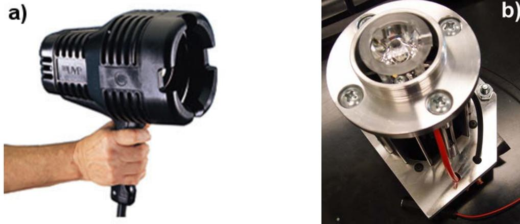
Figure 2.4 Lampes UV utilisées pour la porosification du SiC. a) Lampe UV utilisée à l'Insa (source : [www.uvp.com](http://www.uvp.com)) et b) lampe UV à base de DEL construite à l'Université de Sherbrooke.
