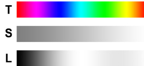
FIGURE 3.3 – Espace colorimétrique TSL (Teinte Saturation Lumière).
