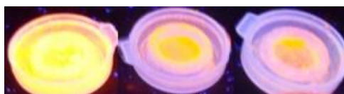
Figure IV-26. Photographie de poudres des composés o -pH-TCF sous lampe UV ( \lambda_{exc} = 365 \text{ nm} ). De gauche à droite : o -pH-TCF, 3-Cl- o -pH-TCF et 5-Cl- o -pH-TCF.
