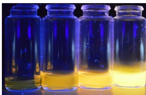
Figure IV-33. Photographie sous lampe UV ( \lambda_{exc} = 365 \text{ nm} ) de 3,4-diMeO-TCF (50 \mu\text{M} ) dans différents solvants : de gauche à droite : THF, éthylène glycol, mélange MeOH/glycérol 10/90, le même mélange glacé (après 5 minutes dans un réfrigérateur).
