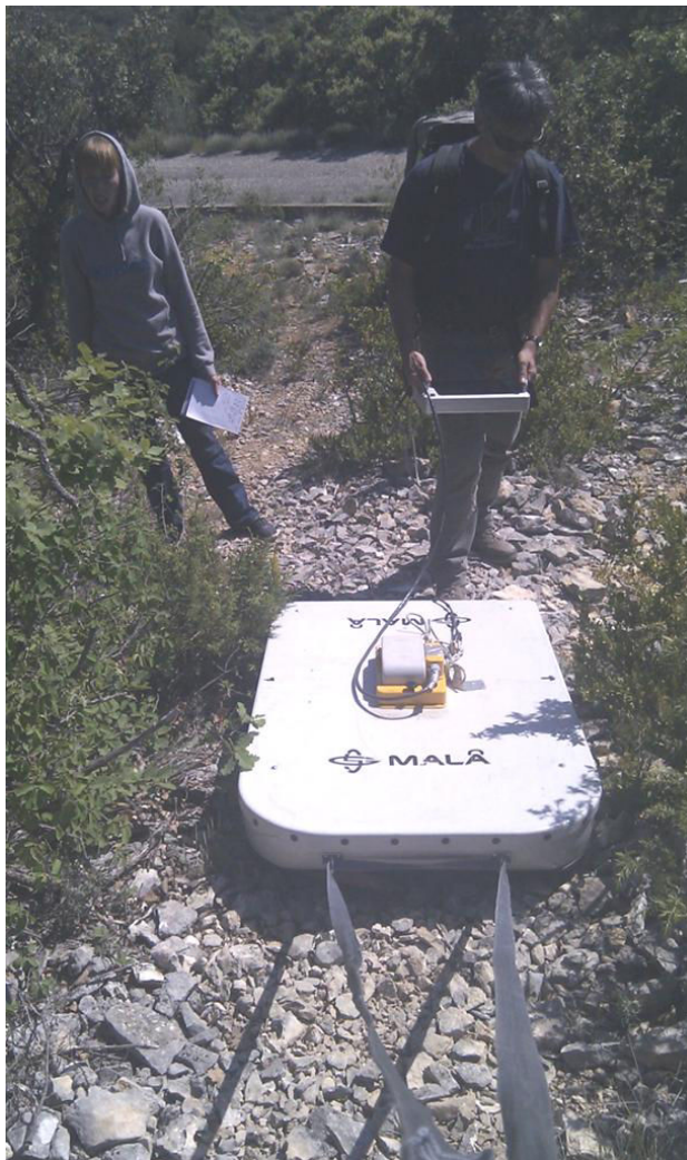
Fig. 40 : Mesure avec le GPR Måla RAMAC sur le site de la sortie de secours du LSBB.
