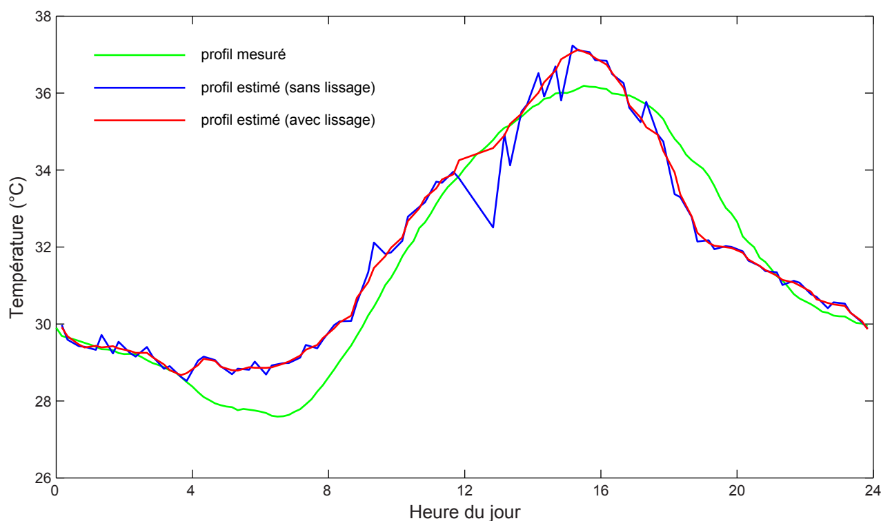
FIGURE 5.13 – Exemple de profil journalier moyen de température pour le mois d'août (Ali Sabieh) ; le profil estimé final est déterminé en lissant le profil original à l'aide d'une régression linéaire locale.
