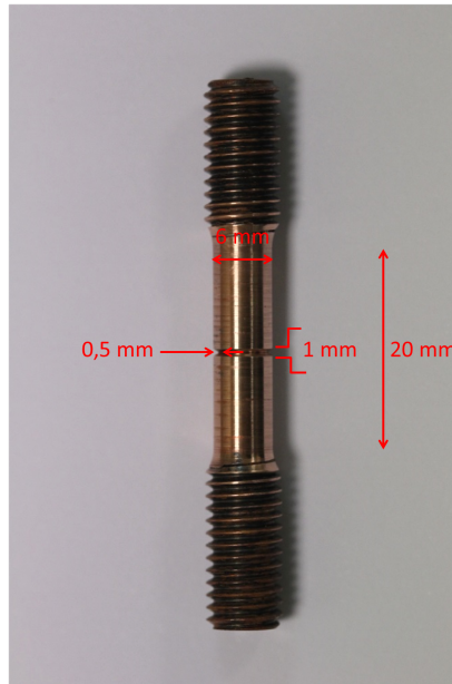
FIGURE 7.11 – Éprouvette cylindrique entaillée utilisée pour les essais de FML en pression
