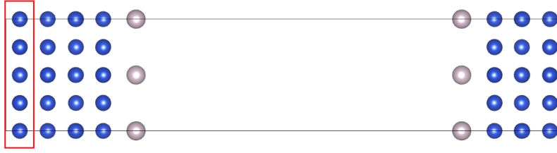
FIGURE 5.2 – Exemple de cellule symétrique utilisée dans un calcul d’adsorption d’atomes de Hg sur Cu(100). Les atomes bleus et gris sont les atomes de cuivre et de mercure, respectivement. Les deux surfaces sont strictement équivalentes et l’adsorption simultanée sur les deux surfaces permet de ne pas créer de dipôle électrique dans la cellule ([33] et [41]). Compte tenu des conditions aux limites périodiques, le cadre rouge indique la couche atomique centrale du cuivre.
