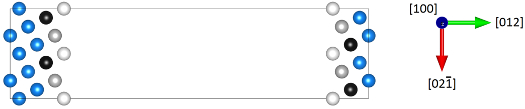
FIGURE 5.8 – Représentation de la cellule utilisée pour la modélisation de la surface Cu(210). Les trois premières couches sont en blanc, gris et noir, les couches intermédiaires en bleu.
