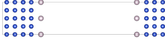
FIGURE 5.3 – Cellule utilisée pour la modélisation de la surface (100). Il s’agit d’un empilement de type « AB... », où les deux surfaces libres sont de même nature (A ou B).
