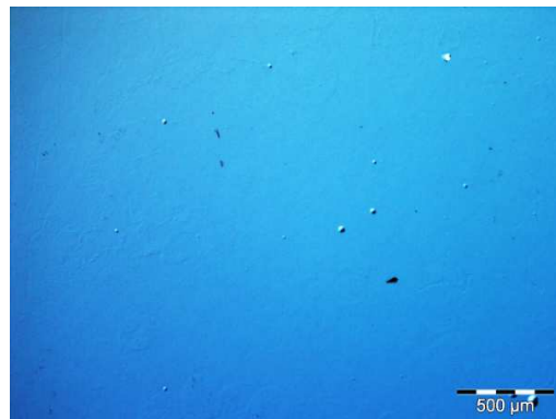
Figure III-25: Image par microscope optique d'une membrane InP collée sur SOI nanostructuré, technologie de nanostructuration réalisée au LPN.
