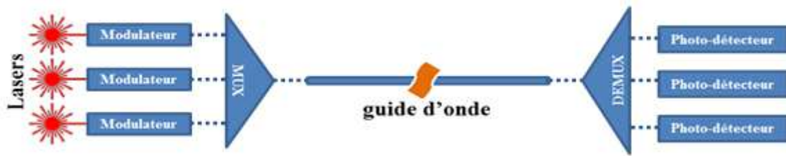
Figure I-1 : Schéma d'un circuit photonique intégré sur silicium
