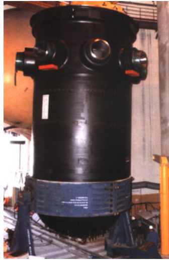
FIGURE 2 – Photographie d'une cuve (en acier) de réacteur nucléaire [SFE].
