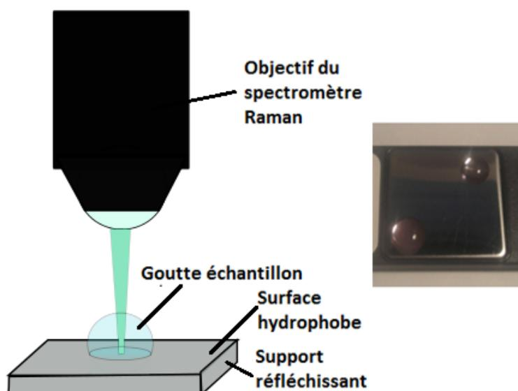
Figure III.13 : Schéma de la méthode de mesure d'une goutte de liquide par spectrométrie Raman. Photo de deux gouttes d'une suspension de nanoparticules sur une lame Tienta®.
