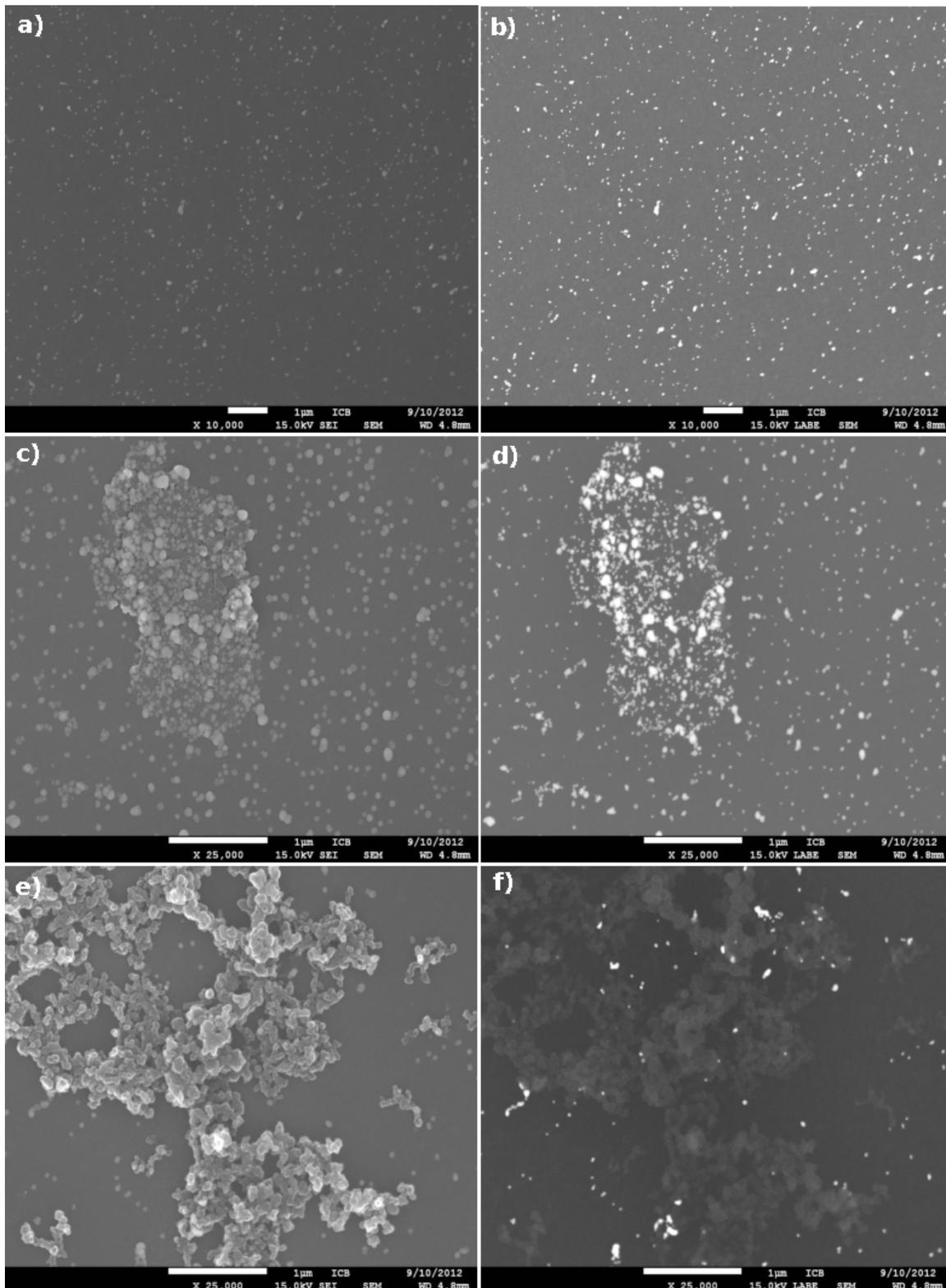
Figure IV.13 : Images MEB d'un film de  $\text{TiO}_2$  de 10 nm d'épaisseur sur substrats de silicium fonctionnalisés avec des nanoparticules d'or. (a, c, e) images enregistrées avec les électrons secondaires ; (b, d, f) images respectives enregistrées avec les électrons rétrodiffusés.
