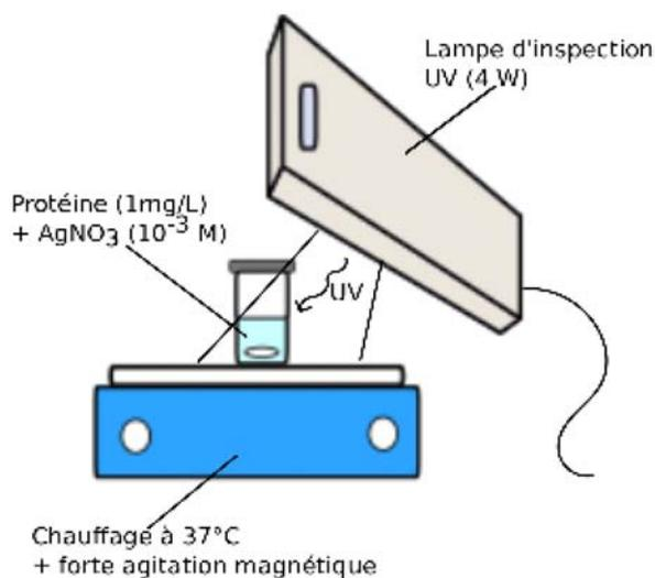
Figure II.11 : Schéma du montage utilisé pour la synthèse des nanoparticules bio-conjuguées sous UV.
