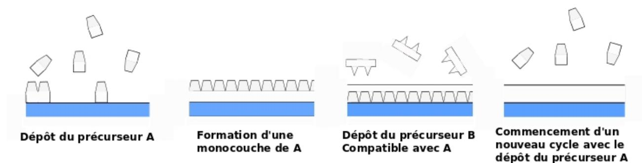
Figure II.12 : Schéma de principe du dépôt ALD.
