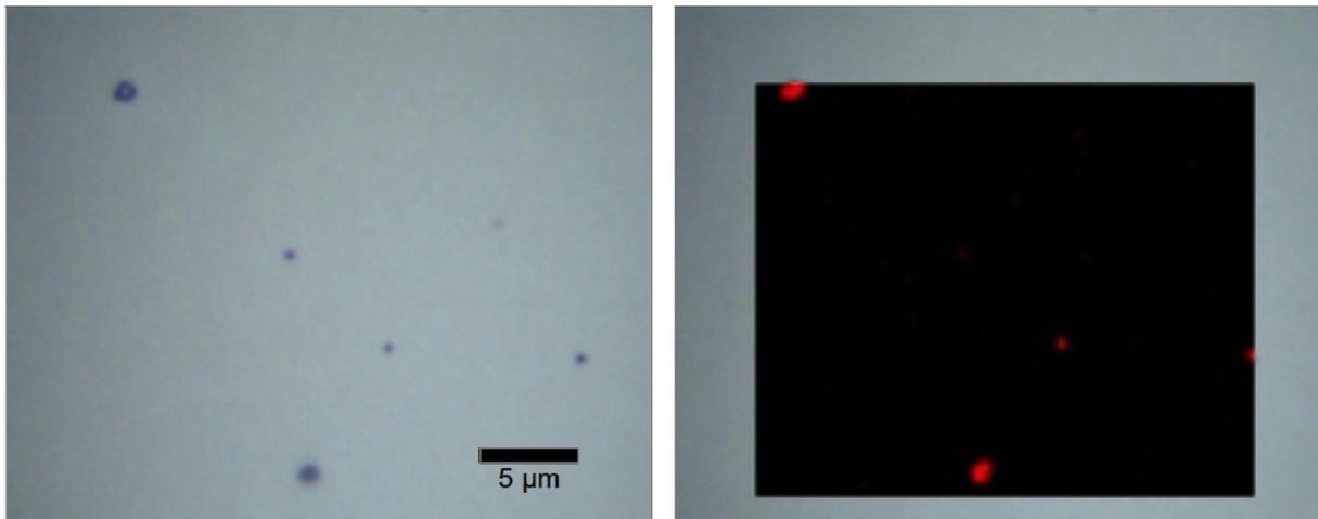
Figure IV.18 : A gauche : image au microscope optique d'une couche de TiO<sub>2</sub> 10 nm déposée sur substrat de silicium fonctionnalisé avec des nanoparticules d'or.
