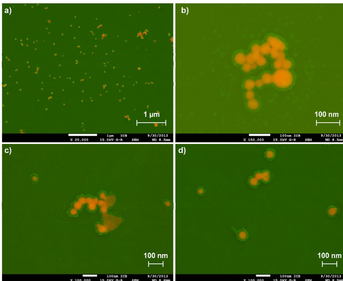
Figure IV.14 : Images MEB des couches de TiO<sub>2</sub> d'une épaisseur nominale de 10 nm déposées sur substrats de silicium fonctionnalisés avec des nanoparticules d'or. Images acquises à la fois en électrons secondaires (en vert) et rétrodiffusés (en orange), puis superposées.
