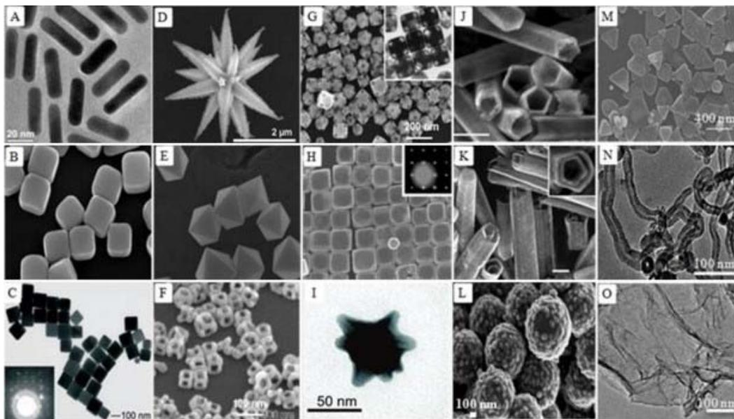
Figure I.14 : Différents types de nanoparticules métalliques [Sidharth Shibua (2013)]
