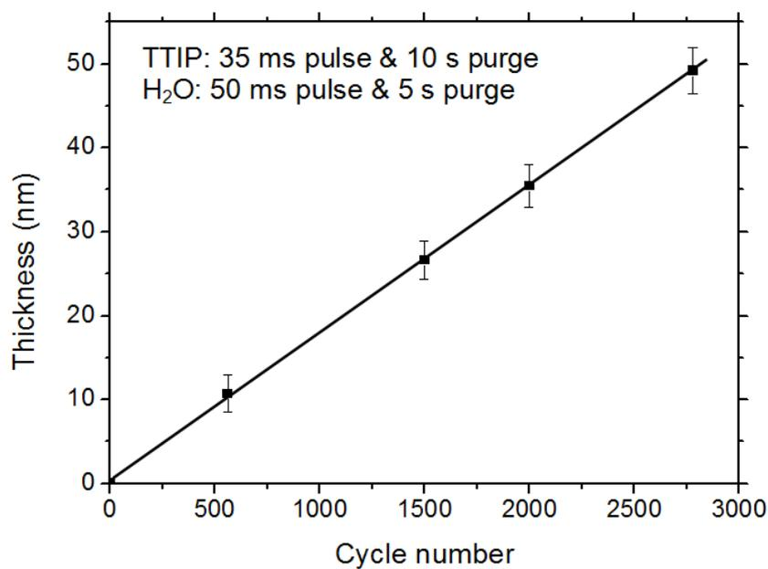
Figure II.13 : Epaisseur des films minces de TiO<sub>2</sub> en fonction du nombre de cycles ALD du dépôt. [Avril (2014)]
