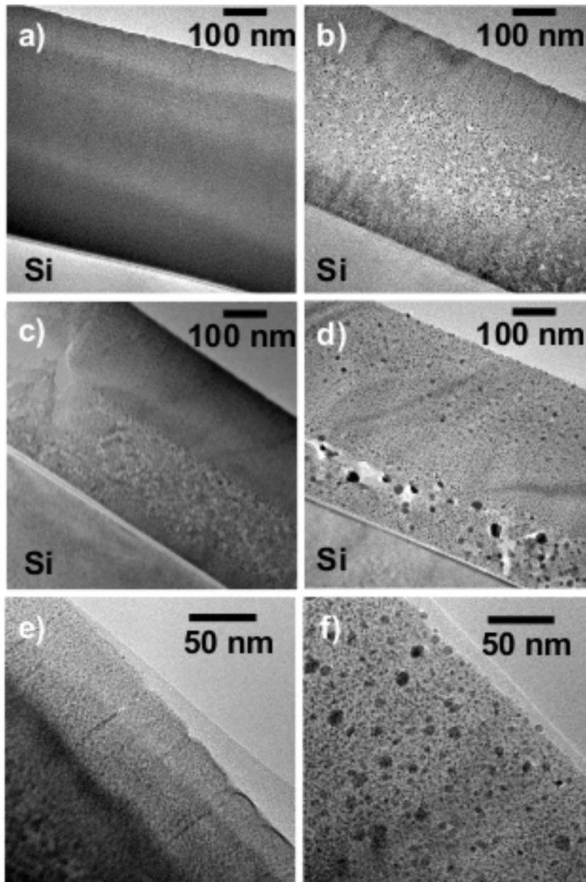
Figure IV.10 : Images TEM de la section transverse des films TiO<sub>2</sub>:Au : (a) échantillon non recuit et (b, c, d) échantillons recuits respectivement à 400, 600 et 800 °C. Des vues zoomées de zones proches de la surface sont données pour les échantillons recuits à (e) 400 °C et (f) 800 °C.
