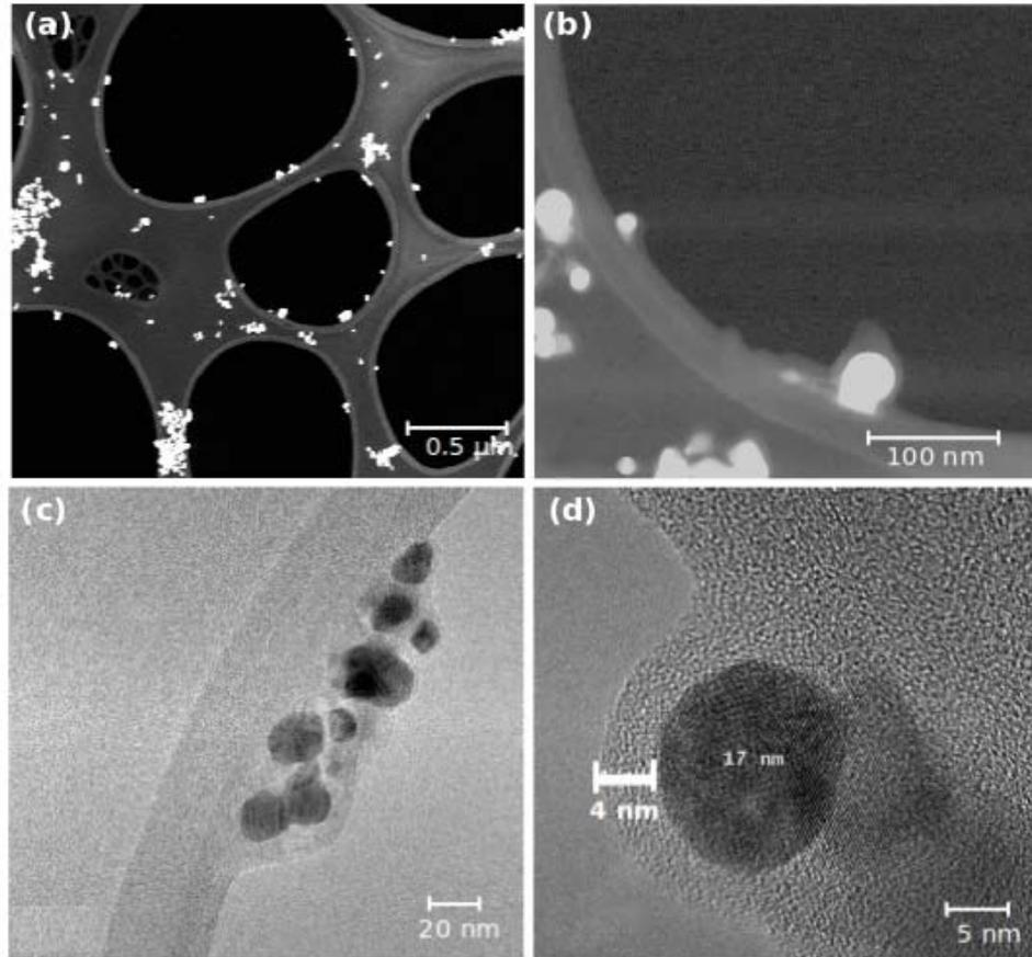
Figure III.9 : Images MET des nanoparticules Ag:Lysozyme sur une membrane de carbone. (a, b) images en champ sombre ; (c, d) images en champ clair.
