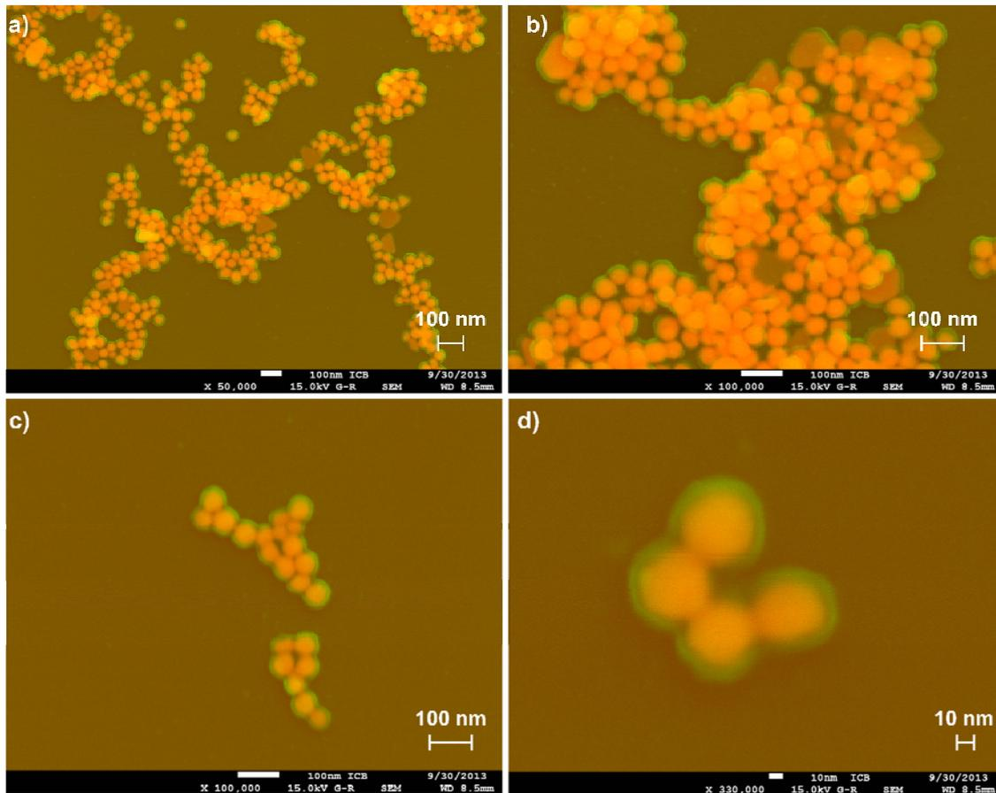
Figure IV.15 : Images MEB des couches de TiO<sub>2</sub> d'une épaisseur nominale de 5nm déposées sur substrats de silicium fonctionnalisés avec des nanoparticules d'or. Images acquises à la fois en électrons secondaires (en vert) et rétrodiffusés (en orange), puis superposées.
