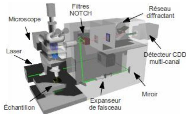
Figure II.16 : Schéma du spectromètre Raman InVia (Renishaw).
