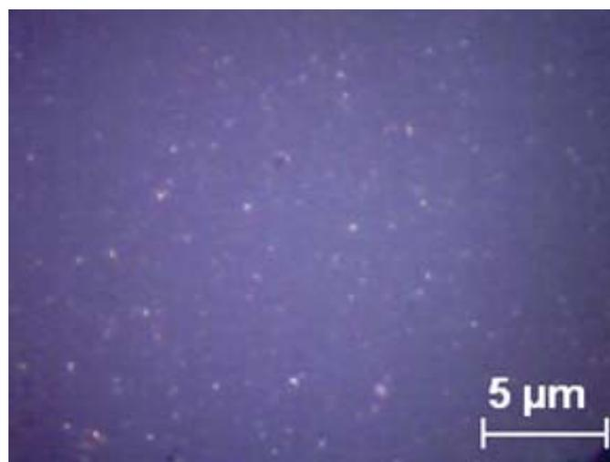
Figure II.7 : Image au microscope optique d'une surface de verre fonctionnalisée avec des nanoparticules d'or.
