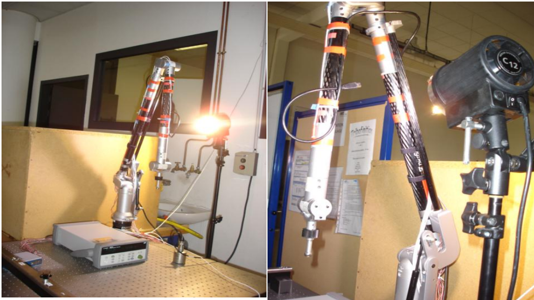
Figure 35: Projecteur utilisé pour chauffer le bras
