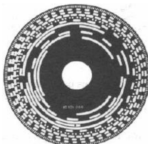
Figure 10 : Disque 12 pistes d'un codeur absolu
