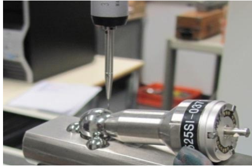
Figure 25 : Photo de l'étude de la stabilité de prise d'un point sur MMT
