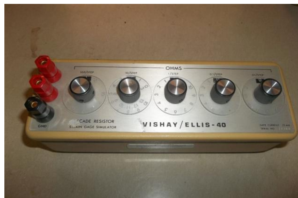
Figure 91: Simulateur de jauges d'extensométrie Vishay / Ellis-40
