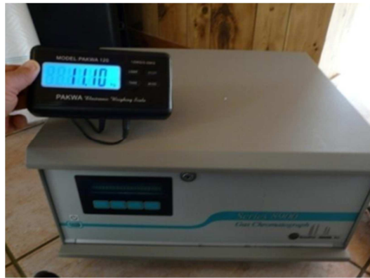
Figure II- 7 Analyseur transportable de BTEX (GC-PID)
