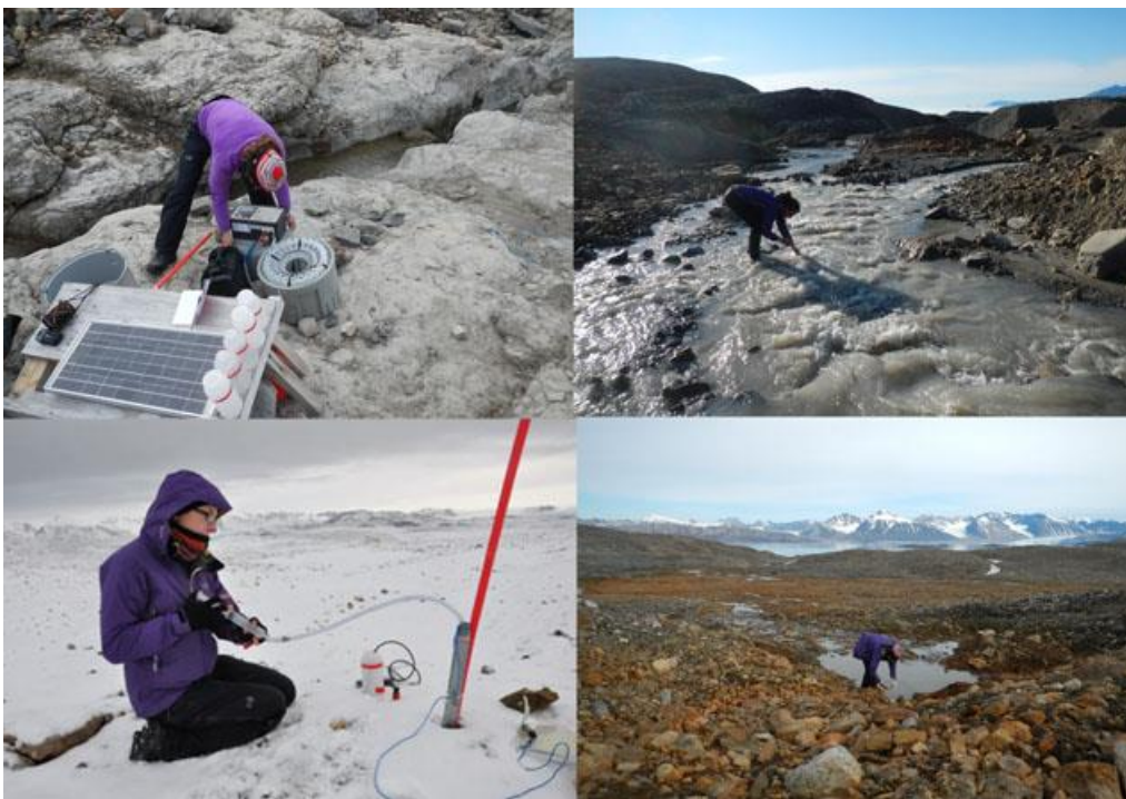
Figure III-21 : Échantillonnage des eaux de surface grâce aux préleveurs automatiques et à des prélèvements directs dans les cours d'eau et, des eaux souterraines en prélevant l'eau des piézomètres grâce à une seringue de prélèvement et en échantillonnant directement au niveau des sources et mares.
