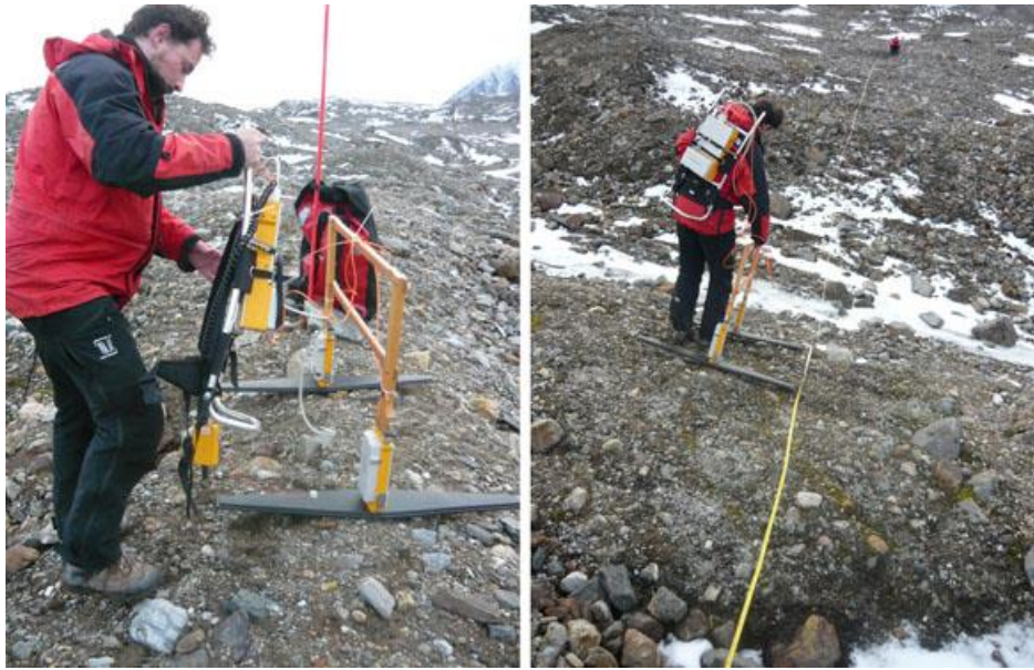
Figure III-20 : Photos des équipements et de la réalisation de profils GPR dans la zone proglaciaire.
