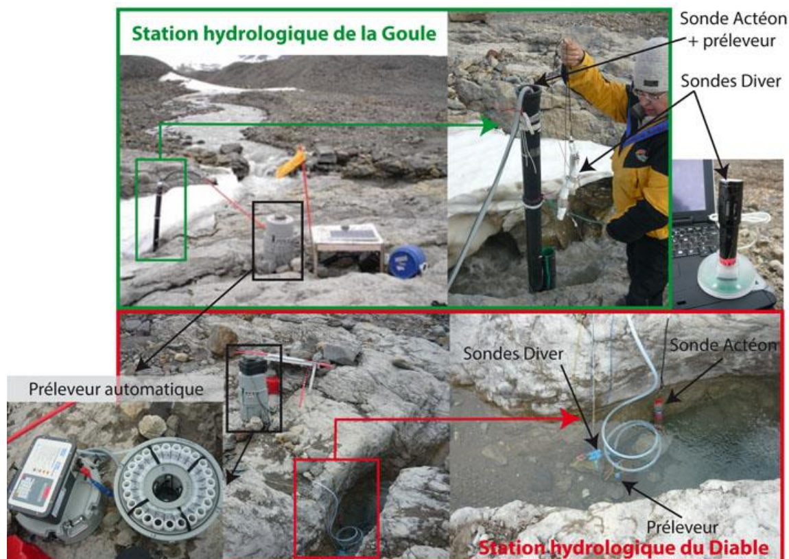
Figure III-5 : Stations hydrologiques de la Goule (cadre vert) et du Diable (cadre rouge) mises en place pour la saison d'écoulement 2012 avec une identification des différents dispositifs de suivi in situ (préleveurs automatiques, sondes Diver et sondes Actéon/aquaclip).
