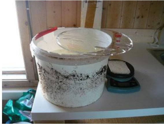
Figure III-3 : Réservoir d'eau utilisé pour les mesures d'évaporation au cours de l'été 2012. Cette photo date du 20 septembre 2012 lorsque le premier disque de glace s'est formé à la surface de l'eau en 24h.
