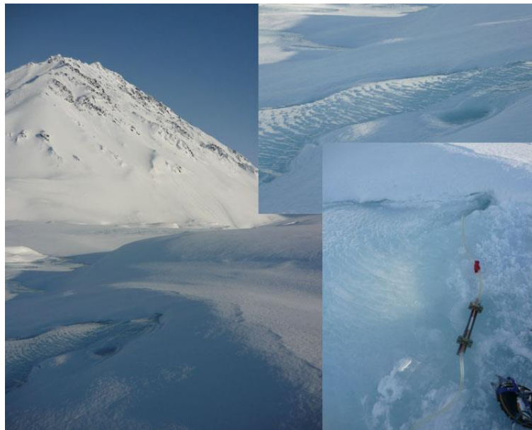
Figure III-23 : Prélèvement d'une marge glacée présentant un flux d'eau continu pour la mesure ^3\text{H} - ^3\text{He} .
