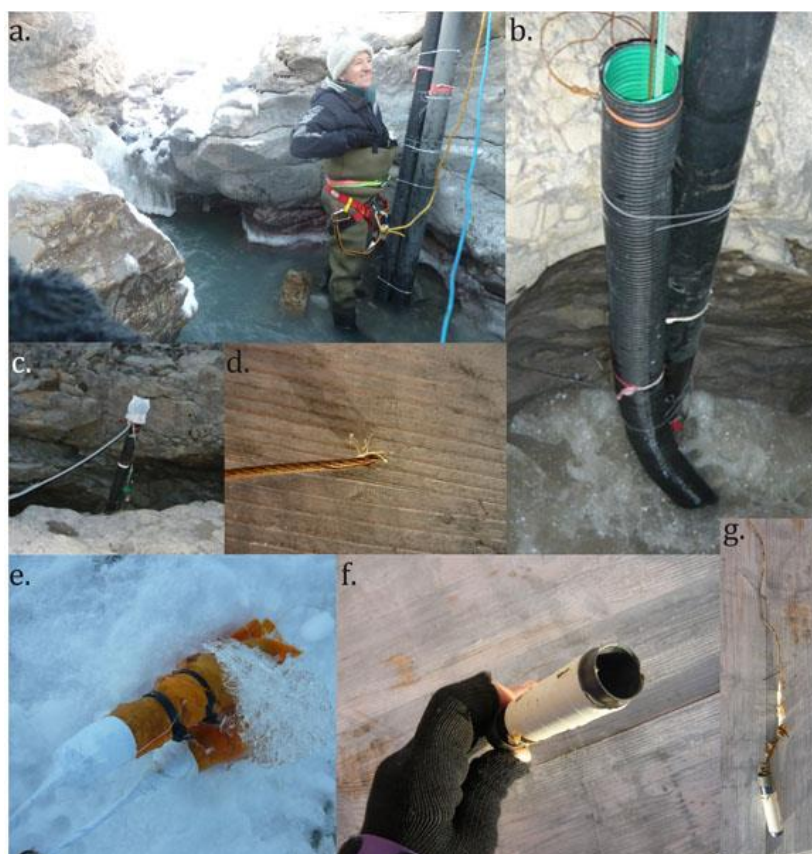
Figure III-6 : Maintenance des dispositifs de suivis à la station hydrologique de la Goule en septembre 2012 : a. intervention sur les tuyaux accueillant les sondes enregistreuses pour les redresser et les refixer à la paroi du canyon à la suite d'un événement qui les a désolidarisés de la roche avec la partie inférieure du tube flexible qui suit le courant (b.) et le tube en dur penché (c.). Cet événement a également entraîné la perte de la moitié des dispositifs de suivi en place suite à la section du câble (d.) qui maintenait la CTD 2012 (Tableau III-2) et l'évidage (f. et g.) de la CTD 2 (Tableau III-2) ; e. 2 sondes de suivis prises par le gel.
