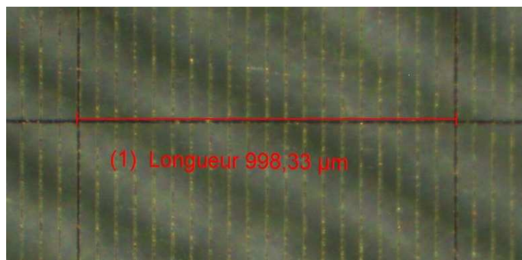
Figure 3.6. Mesures des intervalles entre graduations sur la lame de verre gravée
