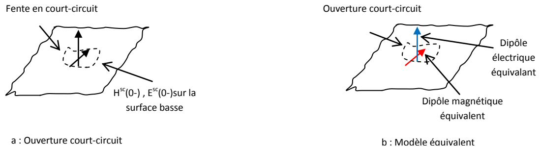
Figure III.4. Illustration de l'excitation et problème équivalent
