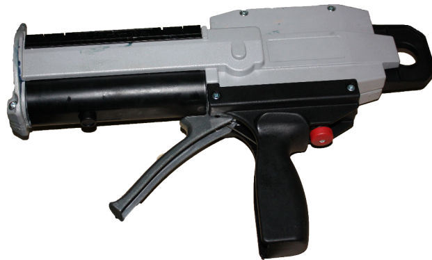
FIGURE A.2: Pistolet doseur et mélangeur de colle.
