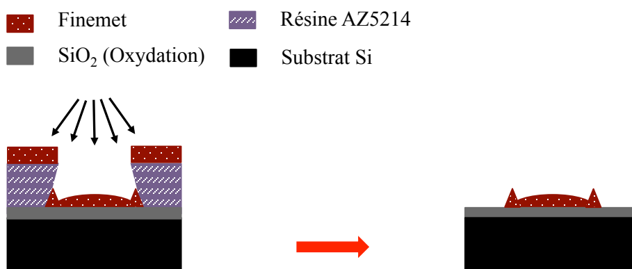
FIGURE 2-4 : Problème lié au dépôt non directif et lift-off classique. L'angle de la résine est de l'ordre de 45°C
