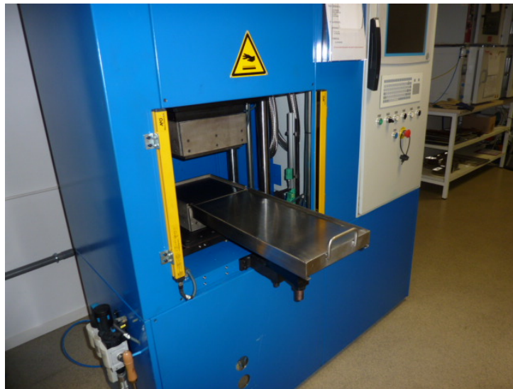
FIGURE 2.12 – Photo de la presse de frittage utilisée dans la réalisation des véhicules de test
