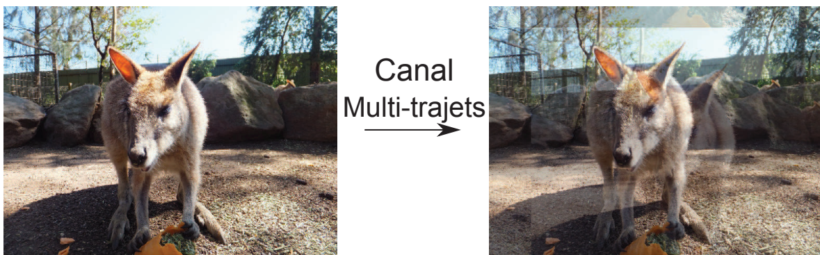
FIGURE 1.3 – Effet d'un canal multi trajets sur une transmission vidéo analogique
