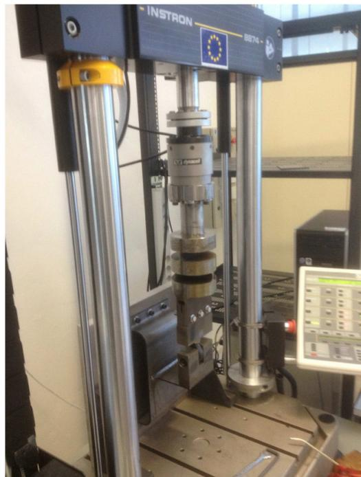
**Figure III-9 Montage développé pour les essais de flexion sur l'éprouvette MS4**
