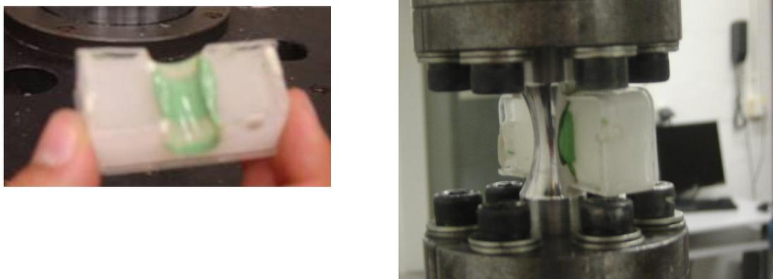
Figure II-6 – Dispositif utilisé pour la réalisation de répliques
