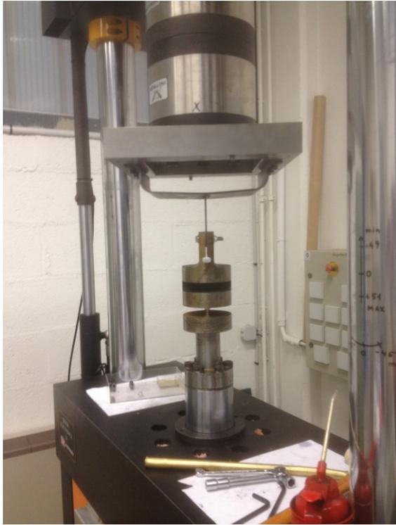
**Figure III-5 Montage de traction développé pour l'éprouvette MS4**
