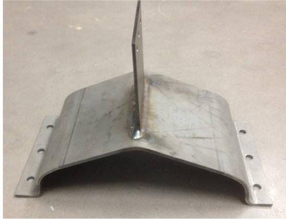
Figure III-17 Éprouvette MS4 après traction monotone
