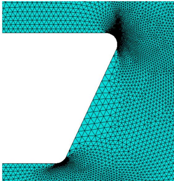
**Figure III-72 Rayon local en racine haute et basse pour le modèle EF 2D**
