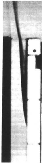
FIGURE 1.7 – Photographie du régime de type couche limite avec zone de recirculation Sparrow et al. (1984) ( $Ra_{T,L} \approx 8.10^4$ ,  $Pr = 5$ ,  $Rf_c = 15.2$ )
