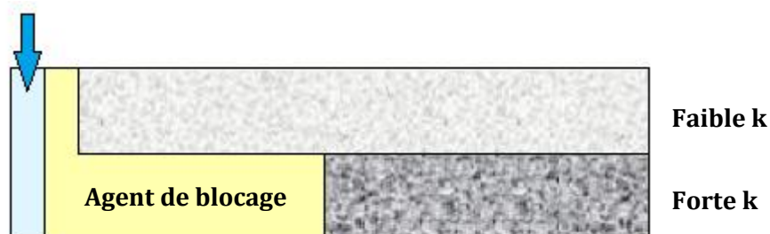
Figure 2.39. Comportement d'un agent de blocage dans un milieu hétérogène.
