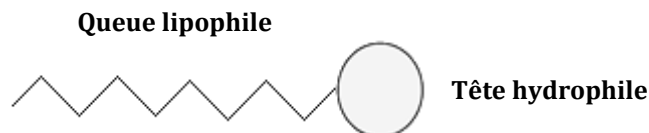
Figure 2.17. Schéma de la structure d'une molécule amphiphile.
