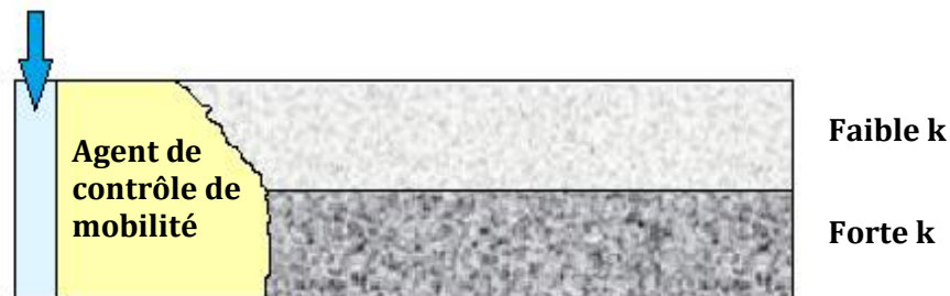
Figure 2.38. Comportement d'un agent de contrôle de mobilité dans un milieu hétérogène.
