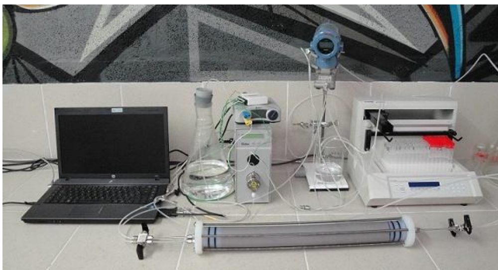
Figure 3.14. Vue générale de l'installation utilisée pour les tests sur colonne.
