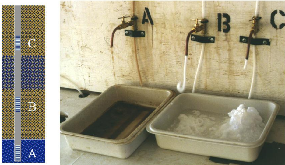
Figure 2.45. Effluent obtenu du puits d'observation MW2 (à droite). A, B et C indiquent la position où le liquide a été prélevé, selon montre le schéma à gauche (Hirasaki et al. , 1997).
