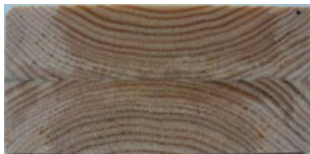
Figure 2.10 – Orientation des lamelles retenue pour l'étude
