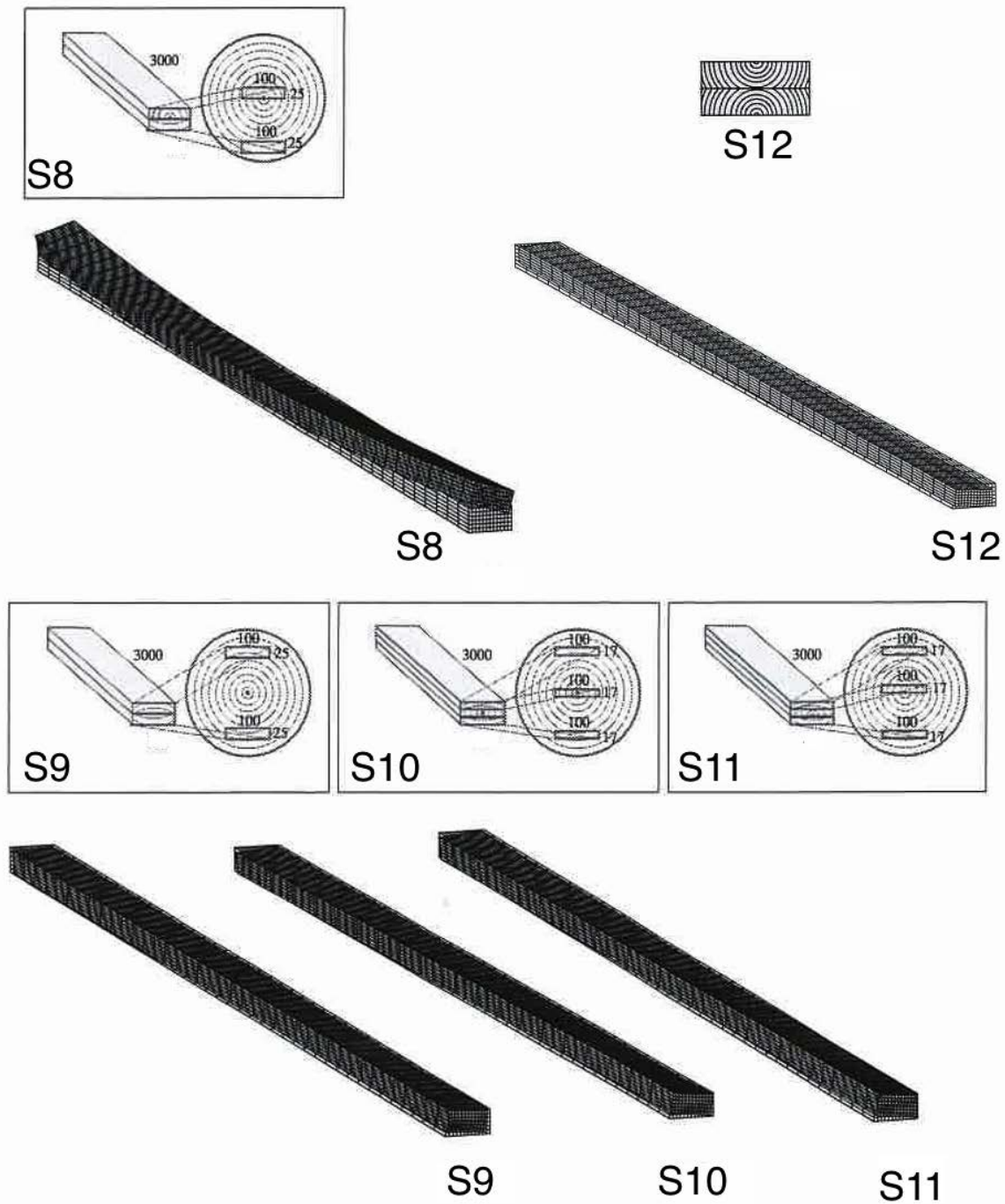
Figure 1.27 – Géométrie des poutres collées étudiées par Ormarsson [20]
