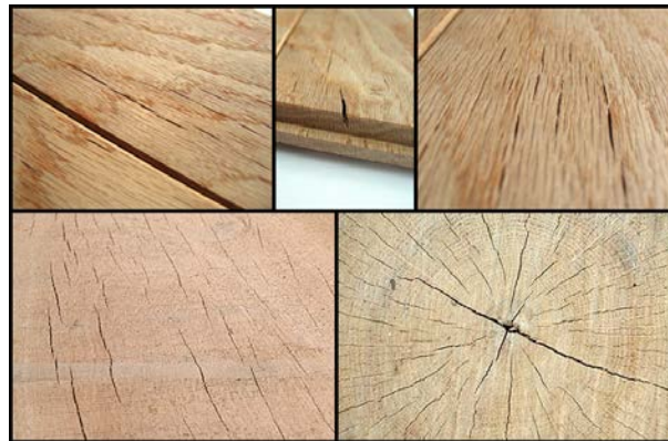
Figure 1.20 – Apparition de gerces et de fendillements internes lors du séchage du bois
