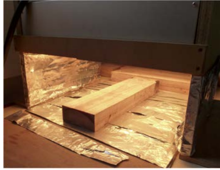
Figure 2.1 – Exemple d’une chauffe d’une planche par panneaux radiants infrarouges
