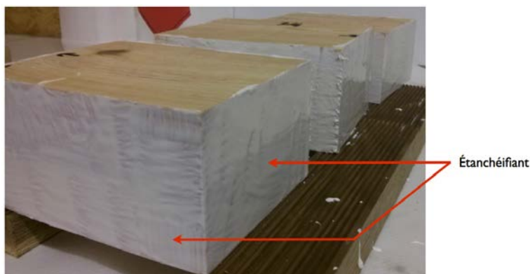
Figure 2.11 – Étanchéification des bords des éprouvettes
