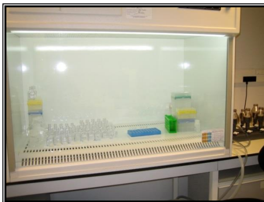
Figure 12. Hotte à flux laminaire classe 100 utilisée pour les expériences de laboratoire
