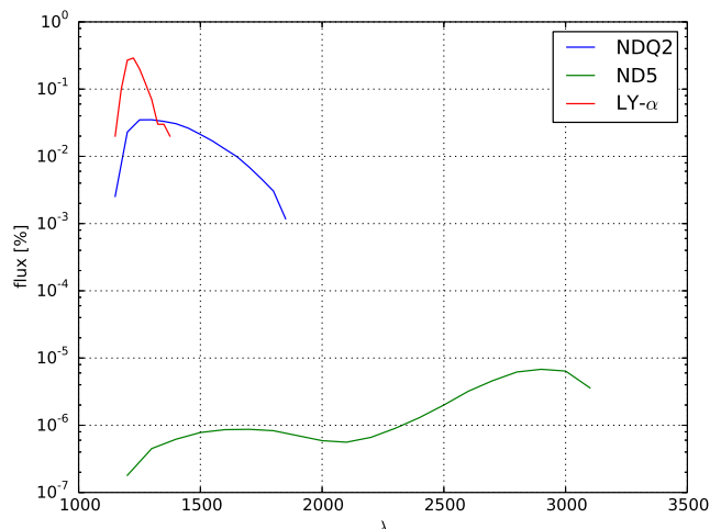
FIGURE 3.1 – Courbes de transmission des filtres utilisés lors des observations HST/STIS de Bételgeuse. Les dénominations NDQ2 et ND5 correspondent à la nomenclature du HST. La longueur d’onde en abscisse est en angströms.
