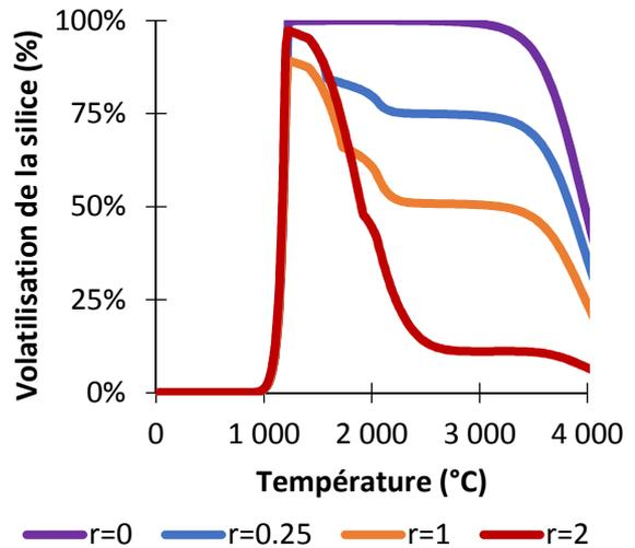
Figure 50 : Influence de la stœchiométrie C/SiO<sub>2</sub> sur la volatilisation de la silice
