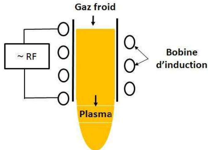
Figure 18 : Principe d'une torche à plasma inductive
