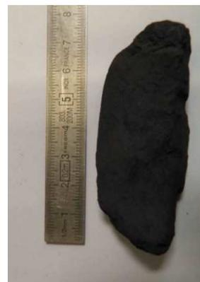
Figure 29 : Sciure de silicium compactée (SiP3-0)
