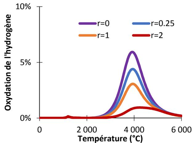
Figure 52 : Influence de la stœchiométrie C/SiO<sub>2</sub> sur l'oxydation de l'hydrogène
