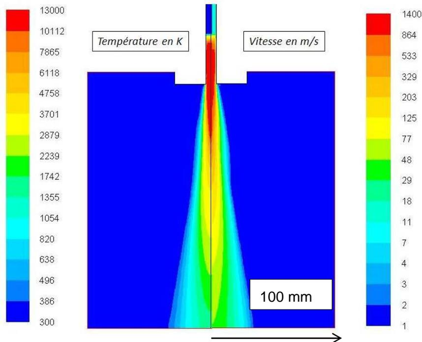
Figure 79 : Champ de température et de vitesse d'un jet de plasma argon-hydrogène s'écoulant à l'air libre (45 (Ar)-15 (H<sub>2</sub>) NI/min, 600 A, tuyère de 8 mm)
