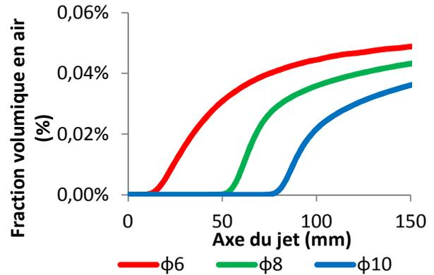
Figure 103 : Variation de la fraction volumique en air résiduel suivant l'axe du jet, en fonction du diamètre de tuyère (atmosphère et plasma Ar-H<sub>2</sub> - 600 A - 44 NI/min)
