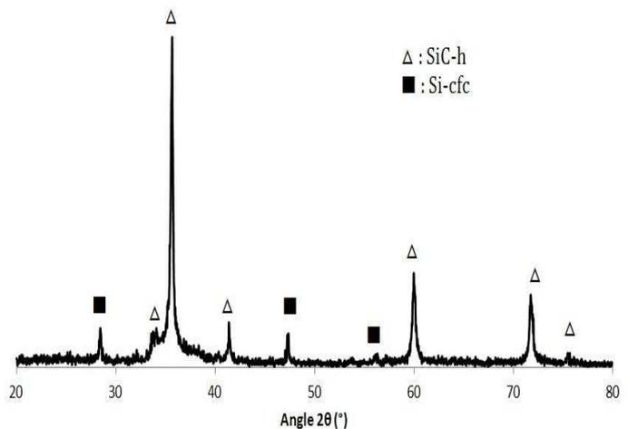
Figure 168 : Analyses aux rayons X de la sciure traitée (I1-0) avec l'injection de méthane
