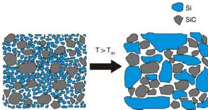
Figure 13 : Recyclage du silicium contenu dans la sciure avec une fusion en four inductif [82]
