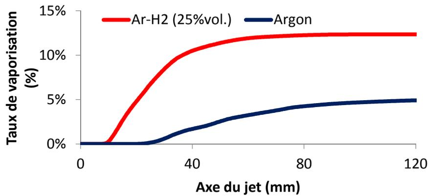
Figure 95 : Variation de la fraction massique vaporisée de particules de 50  $\mu\text{m}$  le long de l'axe du jet, pour un mélange Ar-H<sub>2</sub> et de l'argon pur avec la même enthalpie massique (jet de plasma s'écoulant dans l'air ambiant)
