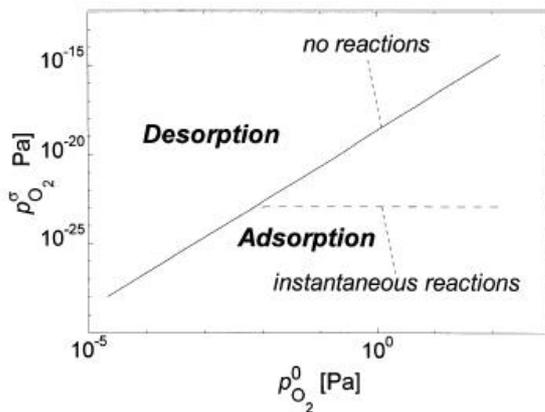
Figure 16 : Régime de désorption/adsorption de l'oxygène en fonction de la pression partielle en oxygène à l'interface liquide/gaz ( $p_{O_2}^o$ ) et de l'atmosphère ( $p_{O_2}^0$ ) [137]
