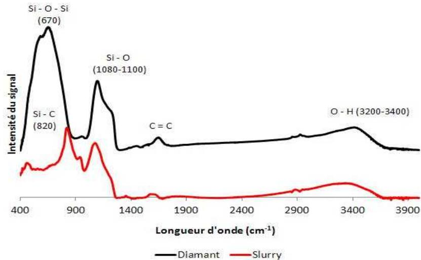
Figure 43 : Spectre infrarouge des sciures « diamant » et « slurry »
