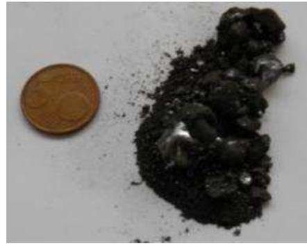
Figure 164 : Pépite de silicium après chauffage de 30 minutes à 1450°C dans un four (10,5 g)
