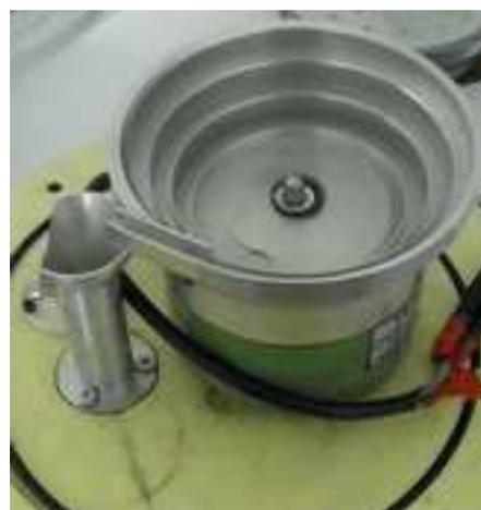
Figure 128 : Bol vibrant et entonnoir de sortie
