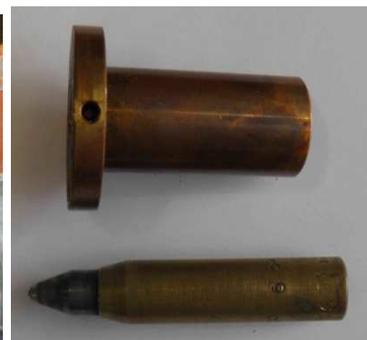
Figure 69 : Jeu d'électrodes : l'anode en haut et la cathode en bas
