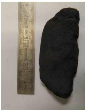
Figure 161 : Sciure de silicium compactée avant traitement (SIP3-0)
