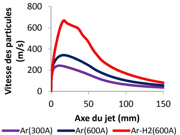
Figure 94 : Variation des vitesses de particules (5 µm) selon l'axe du jet, en fonction du courant d'arc et de la nature du gaz plasmagène, pour un jet s'écoulant dans l'air ambiant
