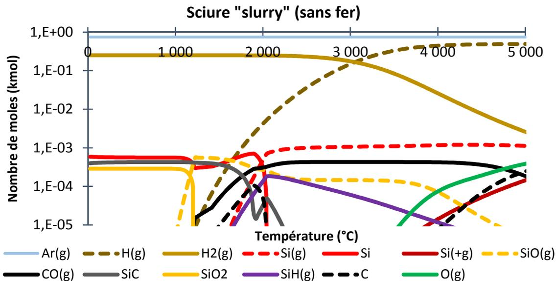
Figure 53 : Composition à l'équilibre pour le mélange E (sans fer) en atmosphère d'argon-hydrogène. Les résultats des calculs en atmosphère d'argon-hydrogène sont illustrés sur la Figure 53. Les nombres de moles des composés « produits » et « consommés » sont représentés en fonction de la température, en atmosphère d'argon-hydrogène à la pression atmosphérique, en considérant ou non la présence de fer (Figure 54 et Figure 55 respectivement).
