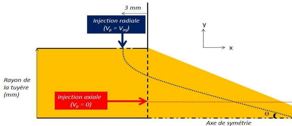
Figure 78 : Injection axiale et injection radiale de la poudre dans le jet de plasma
