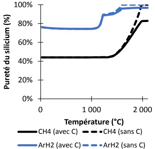
Figure 62 : Variation de la pureté du silicium avec la température
