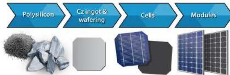
Figure 9 : Du silicium au module photovoltaïque
