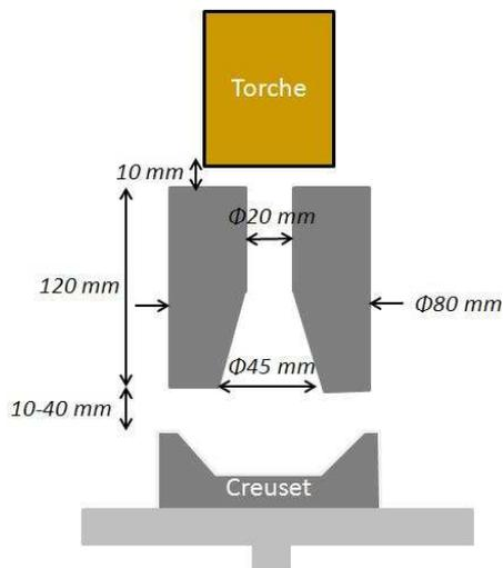
Figure 134 : Caractéristiques géométriques de la configuration expérimentale
