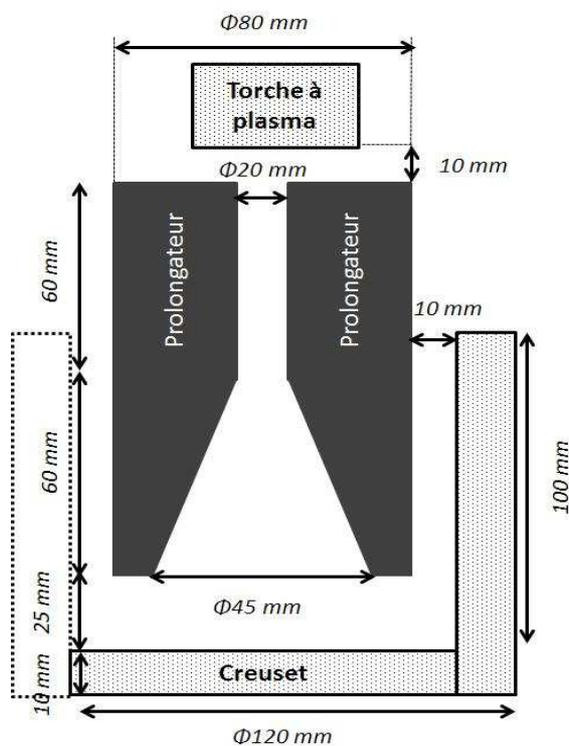
Figure 104 : Paramètres géométriques du système « torche-prolongateur-creuset »
