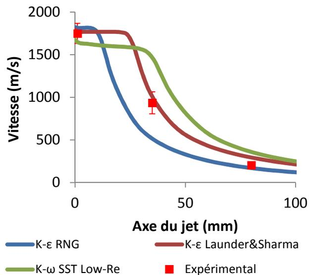
Figure 81 : Variation de la vitesse de l'écoulement le long de l'axe du jet pour différents modèles de turbulence. Comparaison avec l'expérience (plasma Ar-H<sub>2</sub>, 60 NI/min, 25% d'hydrogène, tuyère de 7 mm)
