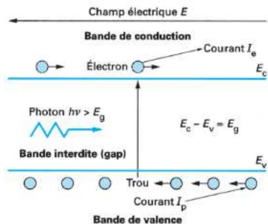
Figure 3 : Principe d'une cellule photovoltaïque [25] Figure 4 : Création d'une paire électron-trou dans un semi-conducteur [26]
