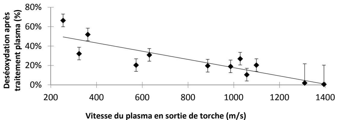
Figure 149 : Influence de la vitesse du jet de plasma (relation (80)) en sortie de torche sur le taux de désoxydation des particules
