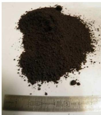
Figure 28 : Sciure de silicium (I1-0) après séchage
