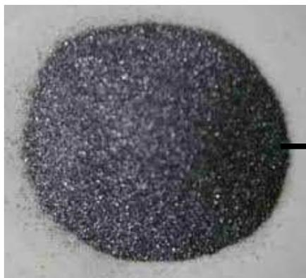
Figure 165 : Poudre de silicium avant traitement plasma (FE1-0)
