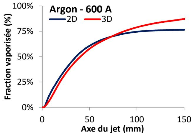
Figure 84 : Fraction vaporisée pour des particules de silicium de 5  $\mu\text{m}$  injectées suivant l'axe du jet, en 2D et en 3D (plasma Ar, 600 A, tuyère de 8 mm)
