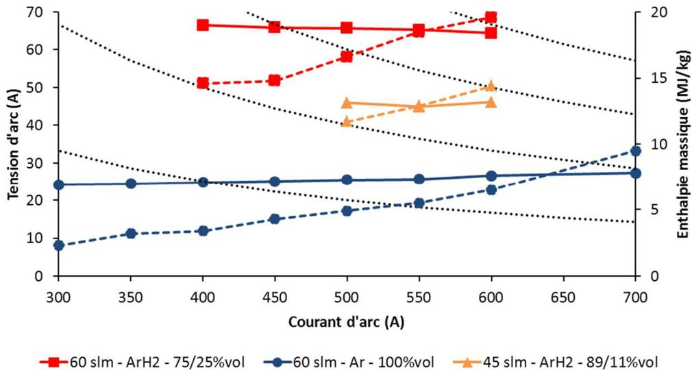
Figure 70 : Variation de la tension d'arc et de l'enthalpie massique en fonction du courant d'arc, pour différentes compositions et débit du gaz plasmagène (diamètre de tuyère : 8 mm)
