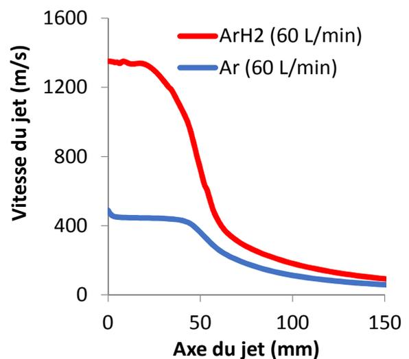
Figure 87 : Variation de la vitesse du gaz selon l'axe du jet en fonction de la composition du gaz, à l'air libre (courant : 600 A, tuyère : 8 mm)
