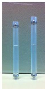
Figure 2.44 -Tubes à perméation contenant une solution d'IBMP
