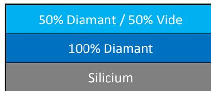
Figure 2.6 - Empilement utilisé pour la mesure d'ellipsométrie.
