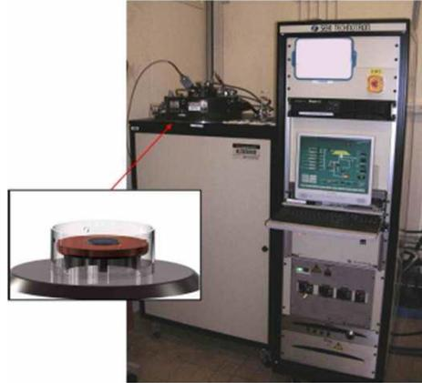
**Figure 2.2** -Photographie du réacteur THOR de type AX6050X et de son enceinte.
