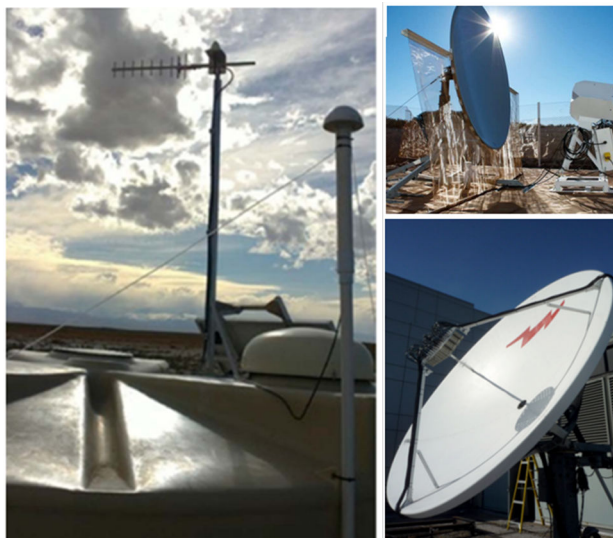
FIG. 1.31 – Photographie des trois expériences de radio détection des gerbes dans le GHz à l'observatoire Pierre Auger : à gauche, une antenne EASIER installée sur une cuve Cherenkov, en haut à droite : AMBER et en bas à droite : MIDAS.
