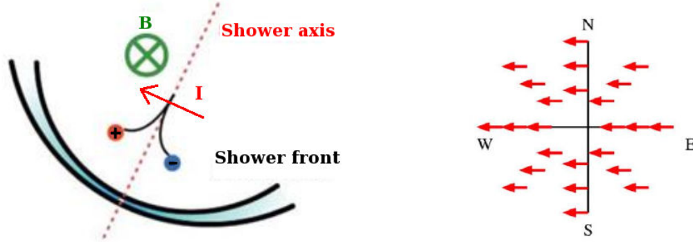
FIG. 1.17 – À gauche : action du champ géomagnétique sur les particules chargées de la gerbe. Un courant transverse perpendiculaire au champ électrique est créé par la séparation systématique des charges positives et négatives, ce courant est la somme des courants transverse individuels des particules composant la gerbe. L'effet du champ géomagnétique induit également la création de dipôles. À droite : champ électrique induit par l'effet géomagnétique mesuré au sol. On observe une polarisation linéaire dans la direction de -\vec{v} \wedge \vec{B} .
