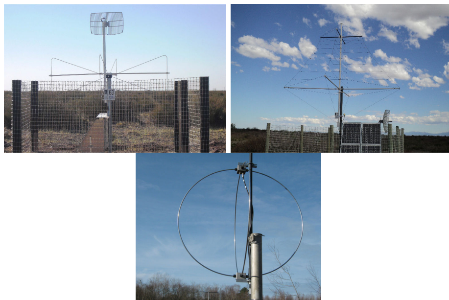
FIG. 2.15 – En haut, de gauche à droite : antennes Butterfly et LPDA, en bas : antenne SALLA.
