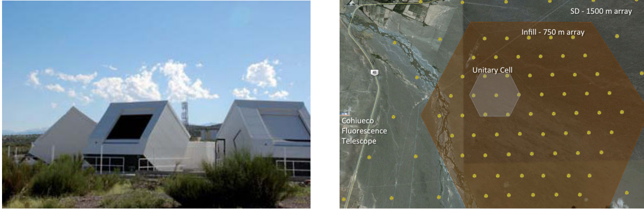
FIG. 1.30 – Instruments installés dans l'extension basse-énergie de l'observatoire Pierre Auger. À gauche : les trois télescopes haute-élévation, HEAT, à droite : carte d'AMIGA, les cuves Cherenkov de l' infill se trouvent dans la zone marron. Le réseau prototype de 7 détecteurs de muons est installé dans la partie Unitary Cell , dans cette zone de 30 m 2 un détecteur de muon est enterré à côté de chaque cuve Cherenkov.
