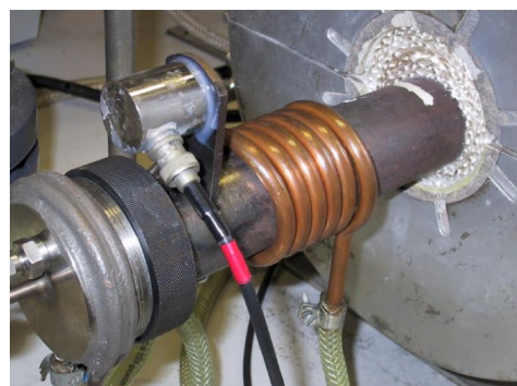
Figure I.9 : Dispositif expérimental de contrôle de la corrosion par metal dusting par émission acoustique [26]
