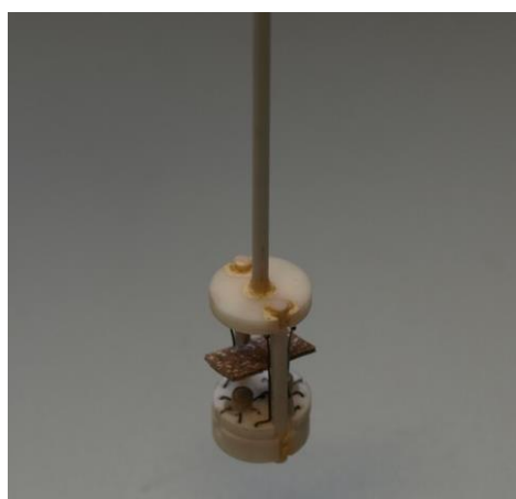
Figure I.47 : Echantillon de Zircaloy-4 serré sur le guide d'onde en alumine
