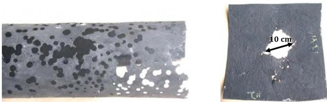
Figure III.2 : Corrosion par metal dusting d'un tube et d'une plaque de l'alliage 800HT observée dans une installation de production de gaz de synthèse [80]
