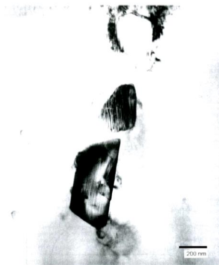
Figure II.2 : Microstructure des précipités \text{Zr}(\text{Cr}, \text{Fe})_2 , d'après le rapport de l'agence internationale de l'énergie atomique en 1998 [60])
