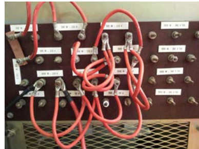
(a) Banc de charge à résistances bobinées
