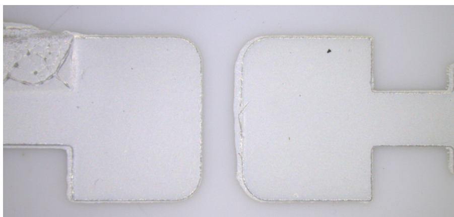
FIGURE 3.3: Photographie d'un véhicule de test "simple" réalisé avec la géométrie initiale et la nanopâte d'argent.
