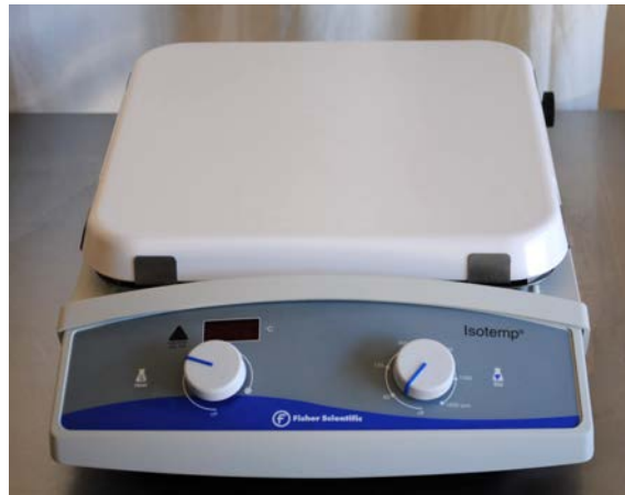
FIGURE 5.10: Plaque chauffante Isotemp (Fisher Scientific) utilisée pour le recuit des résines.
