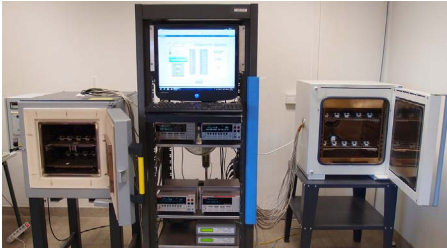
FIGURE 3.12: Photographie des deux bancs de test automatisés utilisés pour l'étude expérimentale du phénomène de migration d'argent.
