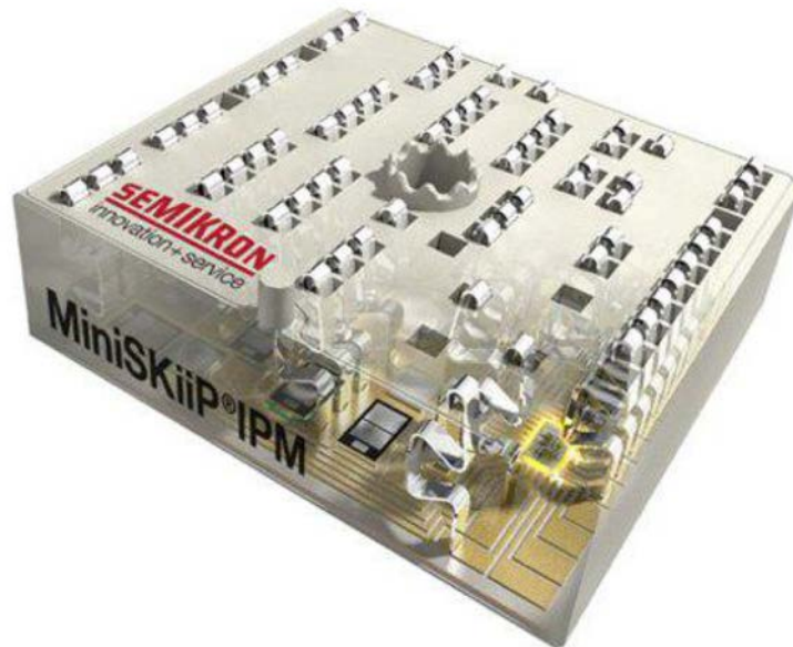
FIGURE 1.26: Module de puissance MiniSKiiP avec des contacts à ressort [11].
