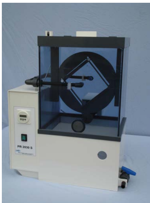
FIGURE 5.8: Photographie de la machine à graver rotative PR 2030-S (Bernier Electronik) utilisée au laboratoire.
