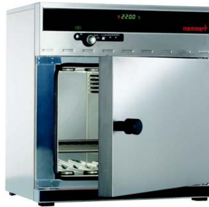
FIGURE 5.13: Etuve UNB 100 (Mettler) utilisée pour le recuit vertical des échantillons recevant des résines déposées par dip Coating .
