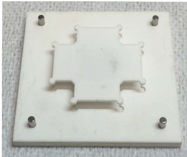
FIGURE 5.28: Photographie de la mise en place des supports pour fritter avec pression la première partie du module. Un grand guide en céramique mesure 5 x 5 cm 2 .
