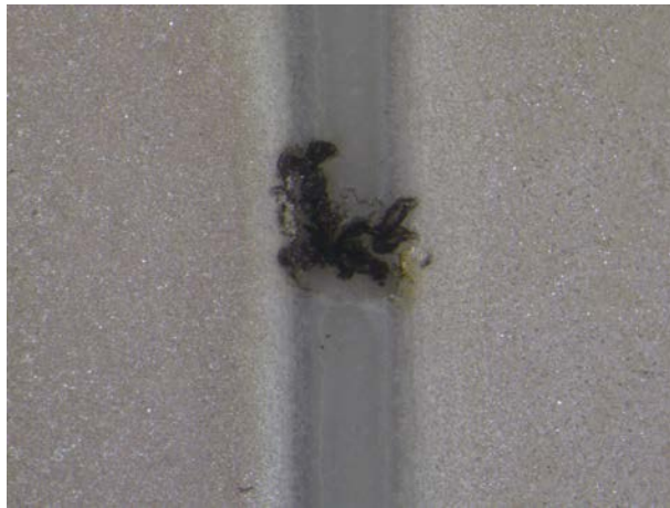
FIGURE 3.25: Photographie d'une brûlure du parylène HT apparue dans l'espace entre les électrodes de 0,3 mm (série n° 13).
