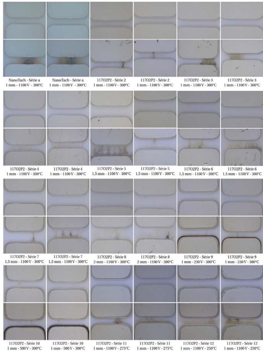
FIGURE 3.20: Photographies de l'espace entre les électrodes de 24 échantillons. Deux échantillons par série ont été sélectionnés. Pour chaque échantillon, les clichés ont été pris avant (en haut) et après (en bas) l'apparition du mécanisme de défaillance.
