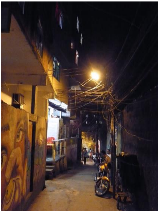
Figures 154 et 155 – La manque d'uniformité d'éclairage des rues commerciales de Pavão-Pavãozinho, avec la formation de trous noirs entre les luminaires. Source Ivone Chou (2010)
