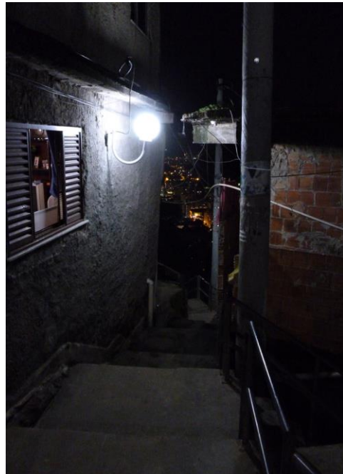
Figures 214 et 215 - L'inadéquation du projet d'éclairage public à Santa Marta. La source de lumière installée dans des endroits inappropriés ou près des fenêtres des maisons. Source : Ivone Chou (2010).
