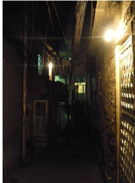
Figures 186 et 187 – La manque d'uniformité de l'éclairage public dans les favelas, avec la formation de zones d'ombre qui nuisent la visibilité et la lisibilité de l'espace. Source Ivone Chou (2010)
