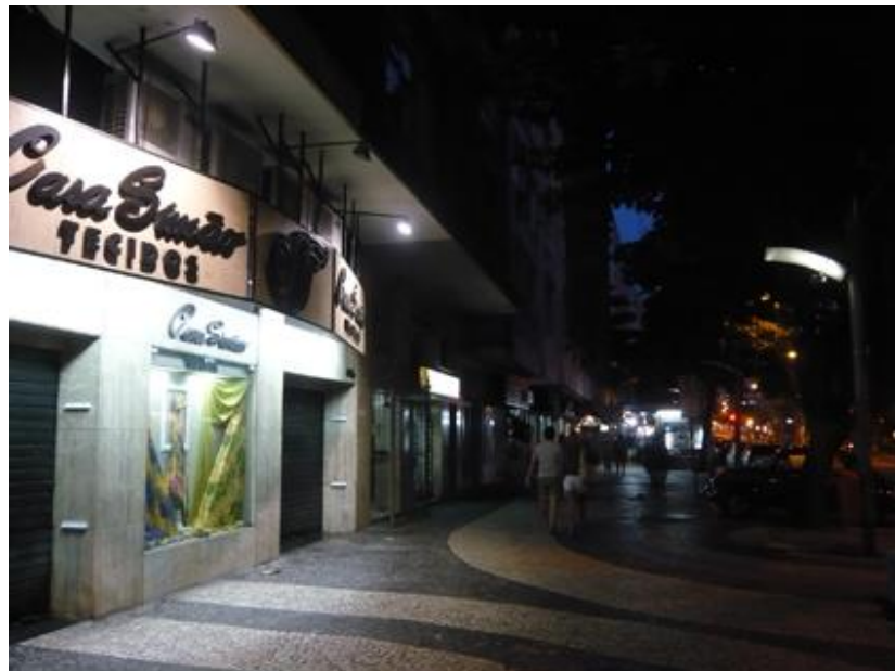
Figure 181 – Malgré l'éclairage du magasin et le lampadaire pour l'éclairage piéton, les arbres font écran à l'éclairage public. Par conséquent, le faible éclairage du trottoir contribue à augmenter le sentiment d'insécurité. Source : Ivone Chou (2010)
