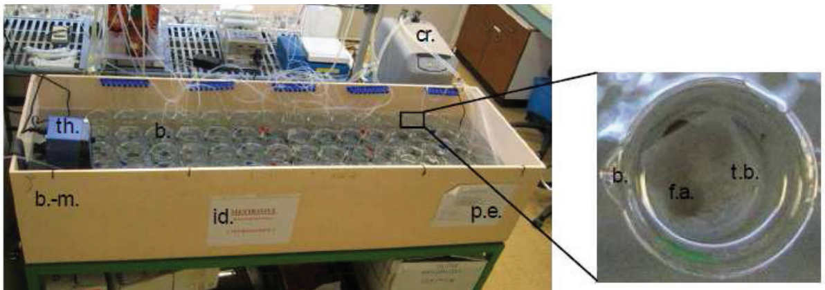
Figure II-15 : Photo du dispositif expérimental utilisé pour l'étude du taux d'alimentation et du taux de croissance.
