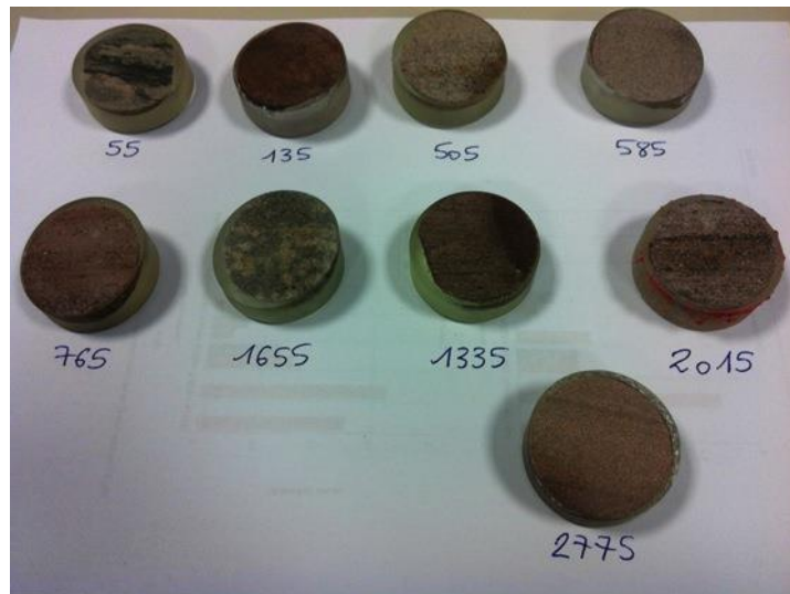
Figure 2-5. Échantillons imprégnés et polis pour analyse MEB + EDS (échantillons de diamètre 38mm).
