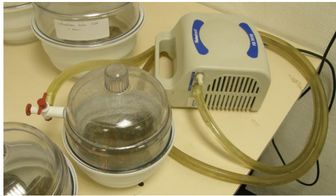
Figure 2-2. Cloche et pompe à vide utilisés pour la saturation des échantillons
