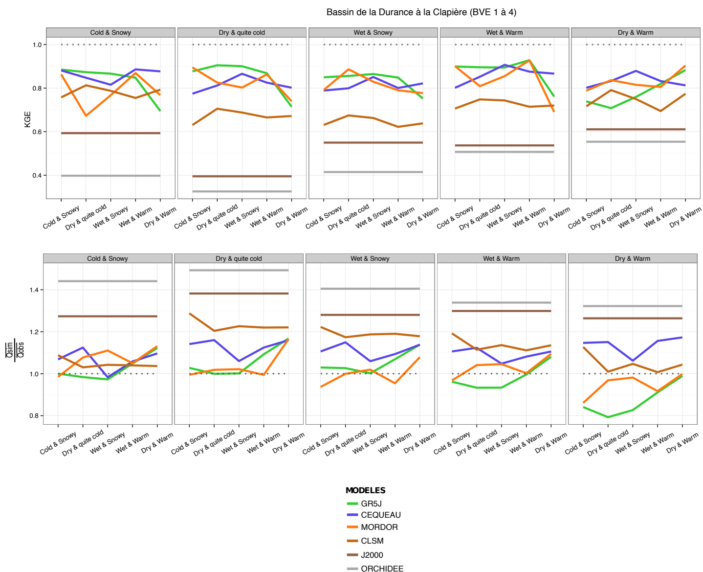
FIGURE A.5 – Comparaison entre les modèles des critères KGE et de rapport de bilan entre les moyennes des débits annuels simulés et observés. Un graphique représente les performances calculées sur les différentes périodes (en abscisse), de six modèles du projet utilisant un jeu de paramètres calé sur la période indiquée dans la partie grisée. Extrait de (Thirel, 2014)
