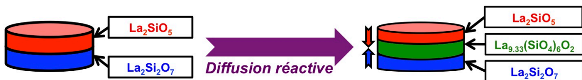
Figure 13 : Schéma du procédé d'élaboration d'oxyapatite à microstructure orientée proposé par Fukuda et al.
